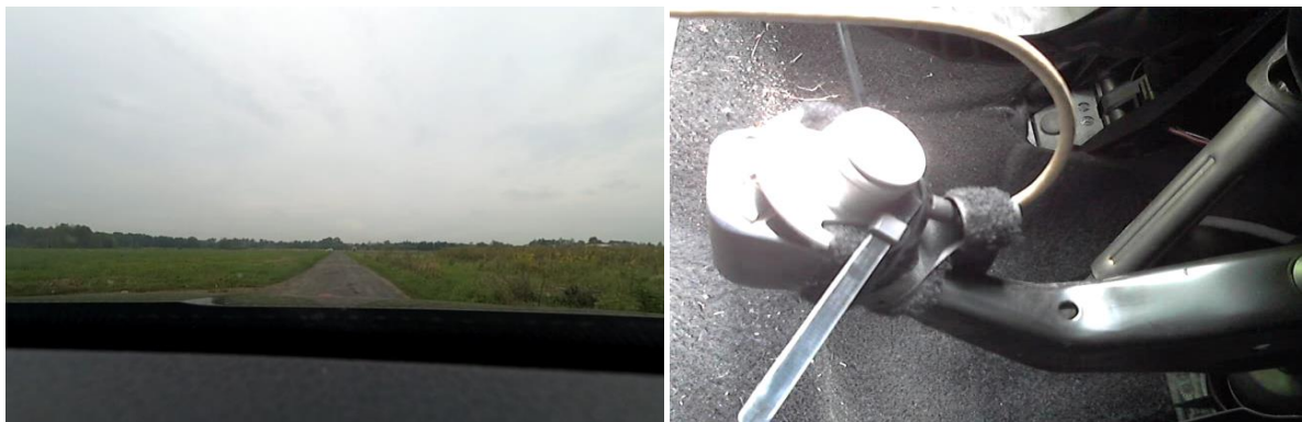
Rys. 58. Widok z kamery przedniej rejestrującej pole widzenia (lewa) oraz z kamery rejestrującej nacisk na dźwignię hamulca (prawa)
