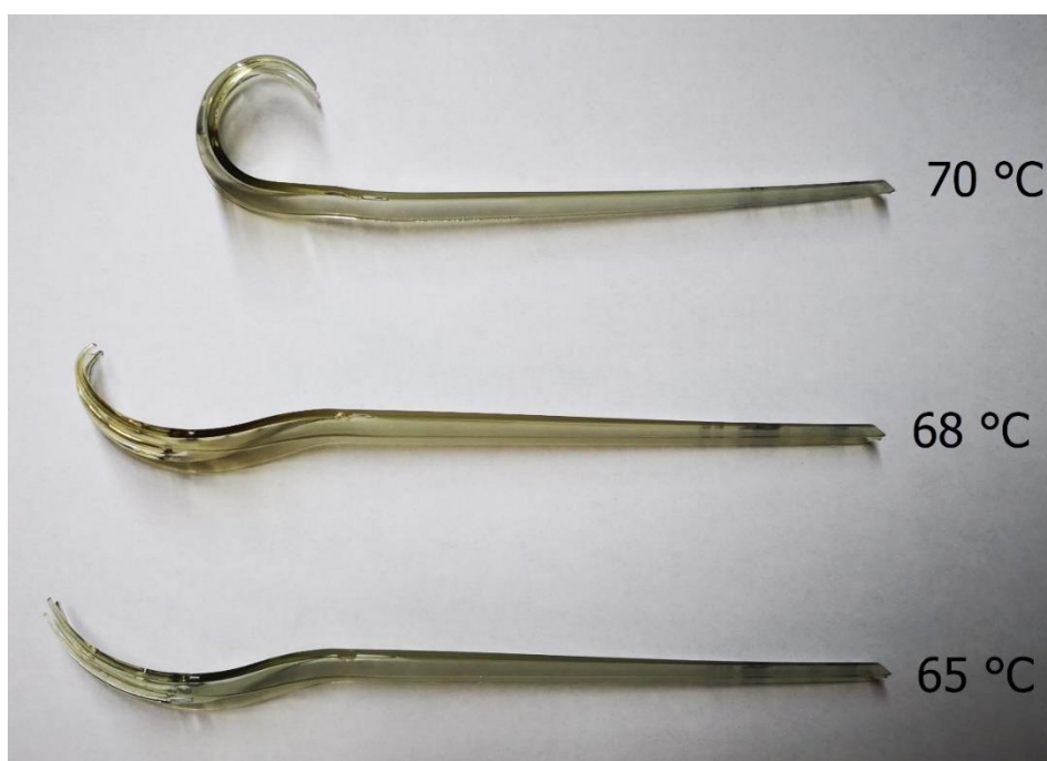
Rys. 7.7. Próbki C po badaniu kryterium termicznego
