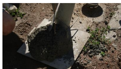
Rysunek 75. Pomiar konsystencji mieszanki betonowej metodą opadu stożka
