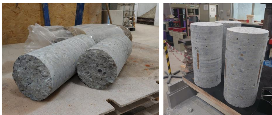
Rysunek 78. Odwierty rdzeniowe oraz przygotowane z nich próbki do badań
