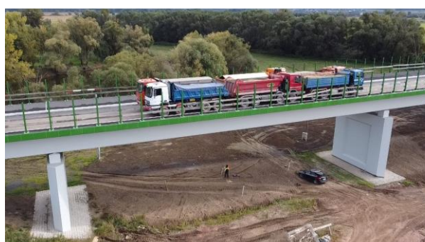
Rysunek 87. Pojazdy obciążające po wjeździe na badane obiekty
