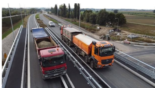
Rysunek 87. Pojazdy obciążające po wjeździe na badane obiekty
