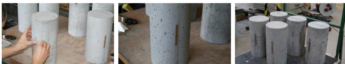
Rysunek 82. Proces naklejania tensometrów elektrooporowych
