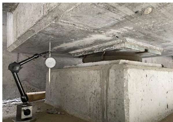
(d) pomiar zgięciu łóżysk czujnikami zegarowymi
