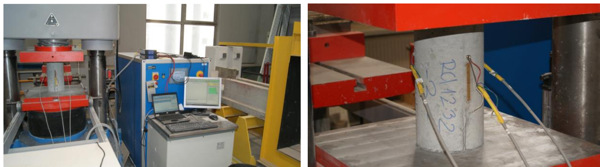
Rysunek 83. Stanowisko pomiarowe do badania modułu sprężystości betonu
