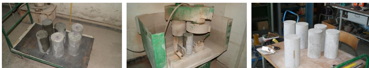
Rysunek 81. Proces szlifowania próbek
