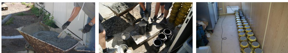
Rysunek 77. Formowanie próbek do badań laboratoryjnych
