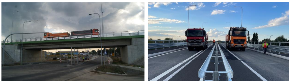
Rysunek 92. Drugie próbné obciążenie obiektu WG-4
