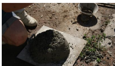
Rysunek 75. Pomiar konsystencji mieszanki betonowej metodą opadu stożka
