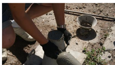
Rysunek 75. Pomiar konsystencji mieszanki betonowej metodą opadu stożka
