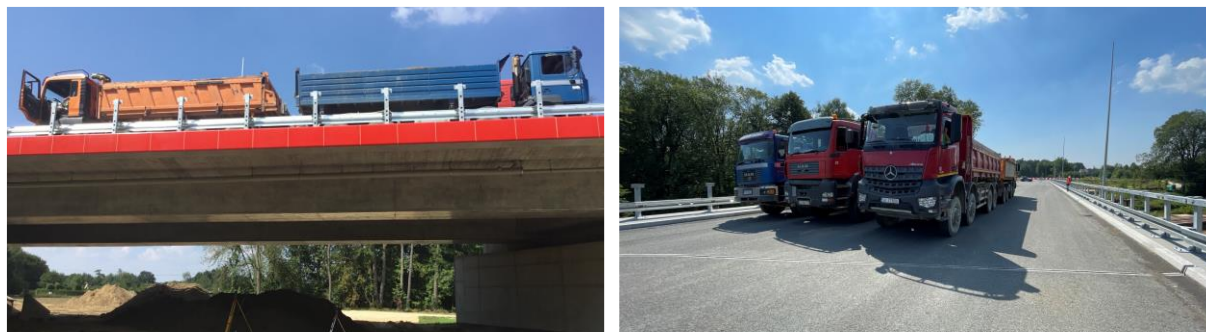
Rysunek 93. Próbne obciążenie obiektu MD-1
