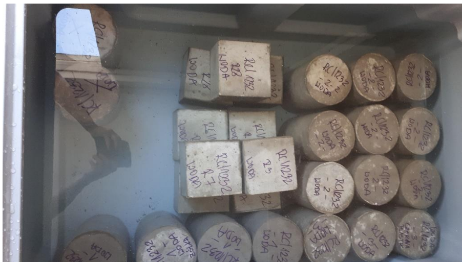
Rysunek 79. Pielęgnacja próbek w warunkach normowych
