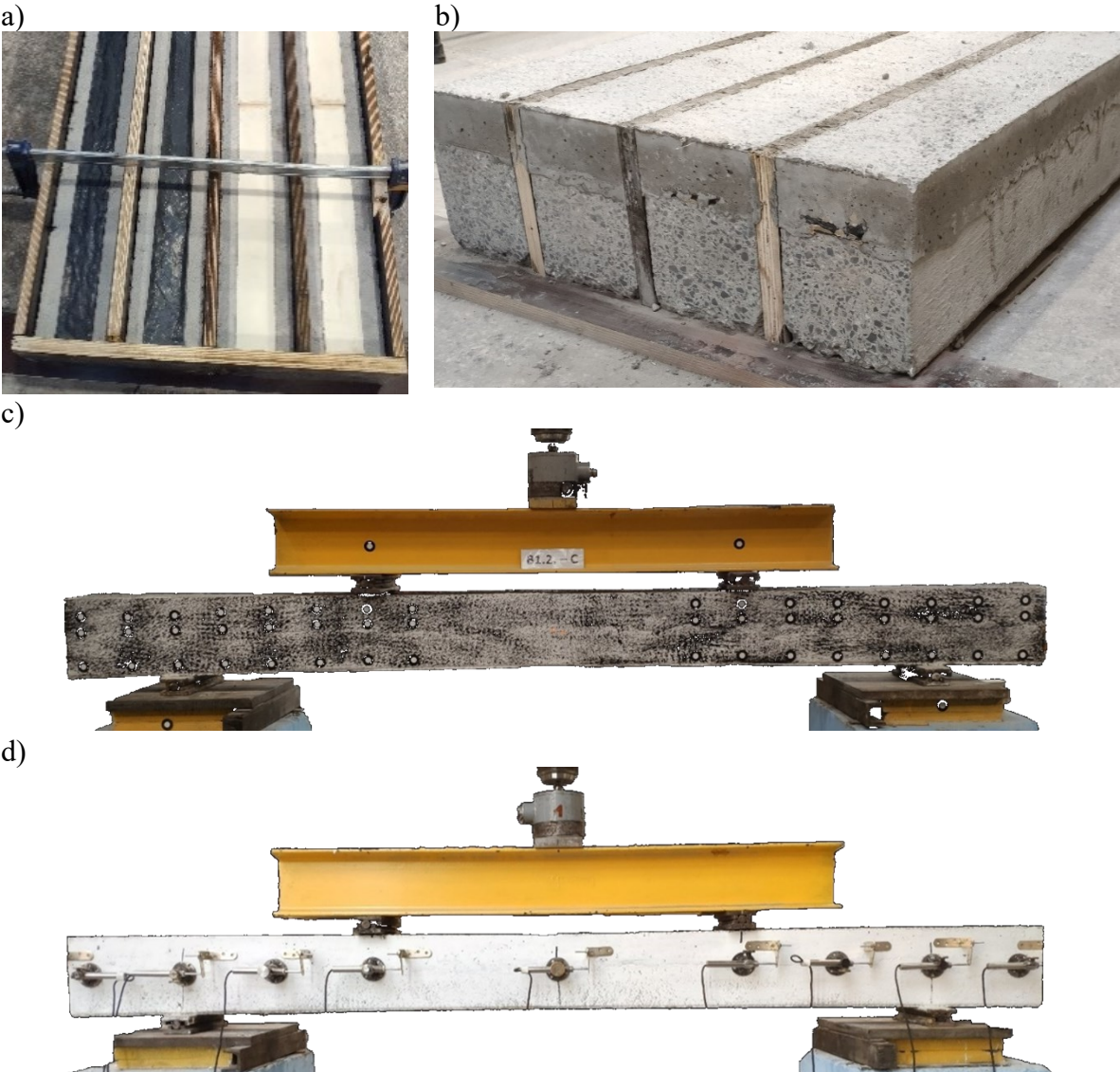
Fig. 5.3. View of the beams: a-b) during and after execution, c-d) on the test stand Rys. 5.3. Widok belek: a-b) w trakcie i po wykonaniu, c-d) na stanowisku badawczym
