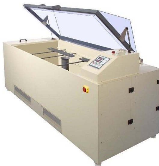
Rysunek 35 Komora do badań korozyjnych
