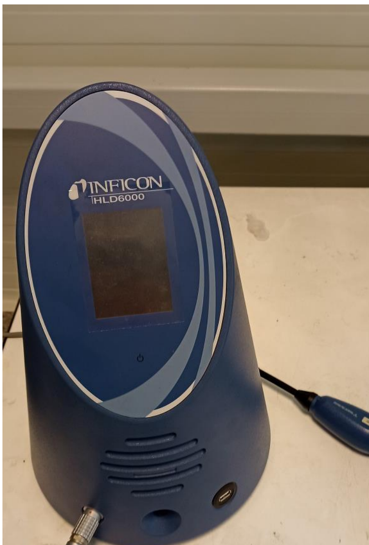
Rysunek 31 Wykrywacz nieszczelności Inficon HLD 6000
