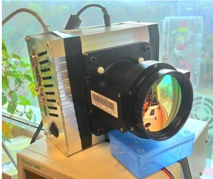
Rys.4.1. Rozwiązanie sprzętowe – niechłodzona kamera termowizyjna o rozdzielczości 1024x768 pikseli.
