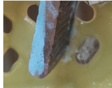
Rysunek 93. Przykład próbki a) CuAl10Ni10 AC i b) CuAl8 DC, widok przed czyszczeniem próbek, widoczne zielonkawe naloty, pochodzące od miedzi
