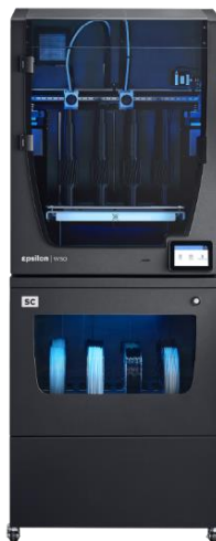
Rysunek 3. Drukarka firmy BCN3D z dwoma ekstruderami [52]
