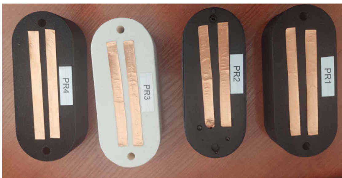
Rys. 93. Widok obudów węzła typu NODE wykonanych różnymi technologiami, gdzie: PR1 - wydruk 3D z filamentu Zortrax ESD spełniającego wymogi rezystancji powierzchniowej [87], PR2 - obudowa wykonana z form silikonowych wykonana na podstawie dostarczonego wydruku 3D, PR3 - wydruk 3D z filamentu ABS, PR4 - wykonanie w technologii druku 3D przez firmę zewnętrzną deklarującą spełnienie wymagań odpowiedniej wartości rezystancji powierzchniowej.
