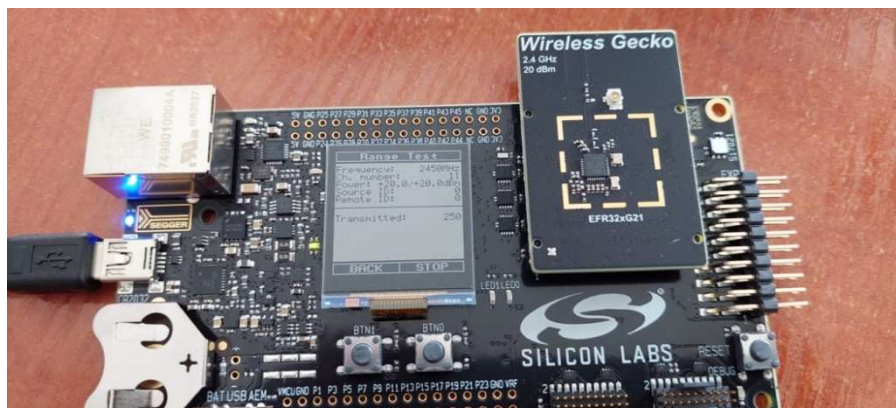
Rys. 44. Widok modułu radiowego EFR32XG21 (skonfigurowany jako nadajnik)
