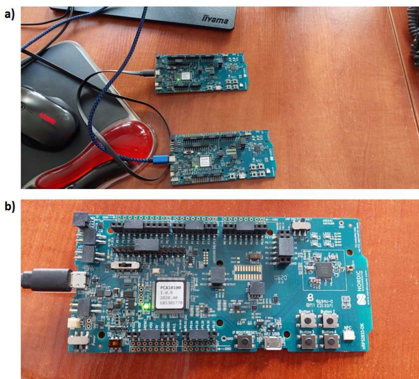
Rys. 37. Widok modułów radiowych nRF52: a) podłączenie dwóch modułów, b) powiększony widok pojedynczego modułu
