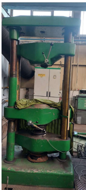
Rys. 94. Stanowisko do badań na ściskanie obudów węzłów sieci sensorycznej
