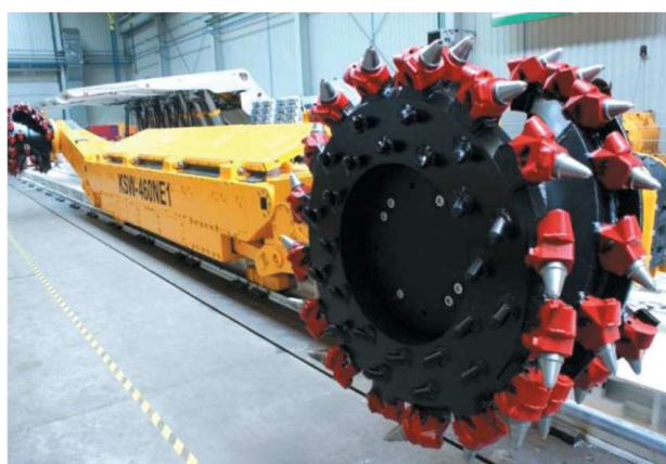
Rys. 3. Widok kombajnu ścianowego KSW-460NE1 firmy Kopex Machinery [5]
