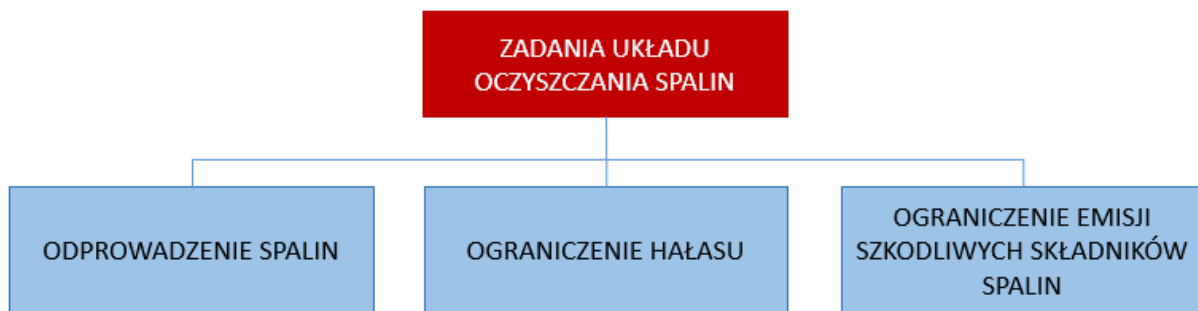
Rys. 2.1 Zadania układu wydechowego
