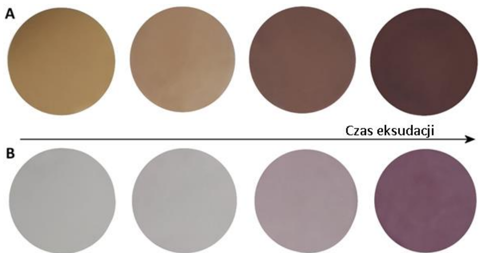
Rysunek 14 Zmiana barwy krążków w czasie badania migracji do LDPE pod obciążeniem (eksudacji). A - wypraski, B - folie wylewane z roztworu.
