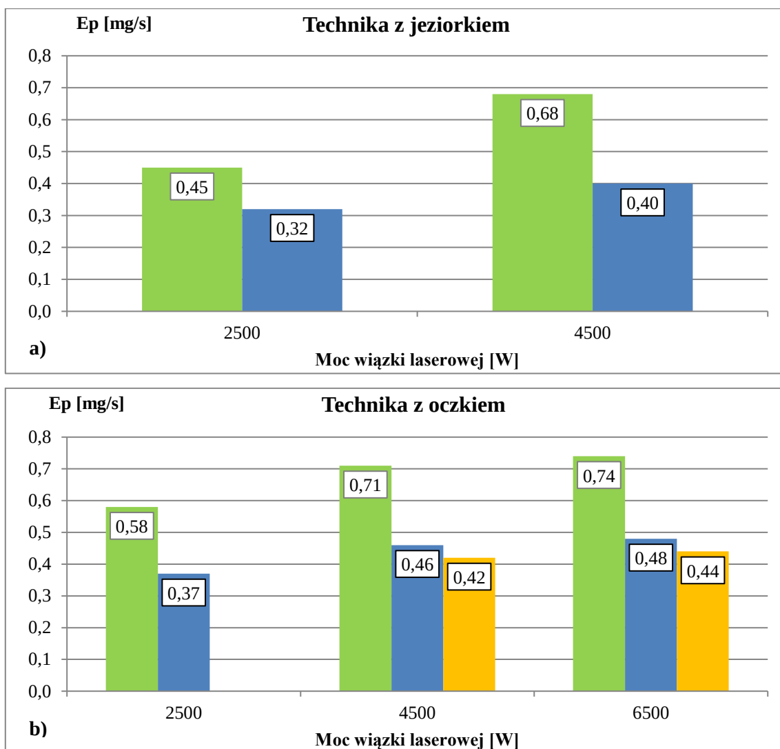
Rys. 5.6. Wpływ wartości mocy wiązki laserowej na wielkość emisji czasowej pyłu podczas spawania laserowego stali 1.4301 techniką: a) z jeziorkiem, b) z oczkiem z prędkością 0,5 m/min (■), 1,0 m/min (■) i 1,5 m/min (■)
