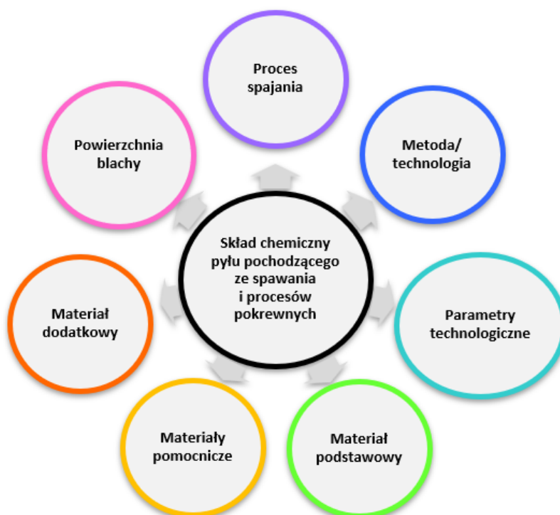
Rys. 1.2. Czynniki wpływające na skład chemiczny pyłu pochodzącego ze spawania i procesów pokrewnych [10]
