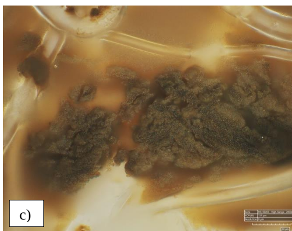
Rys. 6.31. Morfologia pyłu pochodzącego ze spawania laserowego techniką z oczkiem stali 1.4301 a) pył zebrany na filtrze, b) cząstki pyłu zebrane w aglomeraty - obszar zaznaczony na czerwono, c) i d) widoczne drobne cząstki pyłu o kształcie podłużnym, nieregularnym i zbliżonym do kulistego tworzące aglomerat
