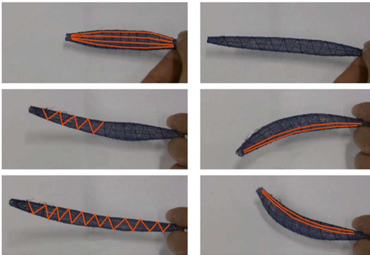
Rysunek 3.3. Aktywator wykonany na podstawie drutów NiTi odwzorowujących ruchy ślimaka [148]
