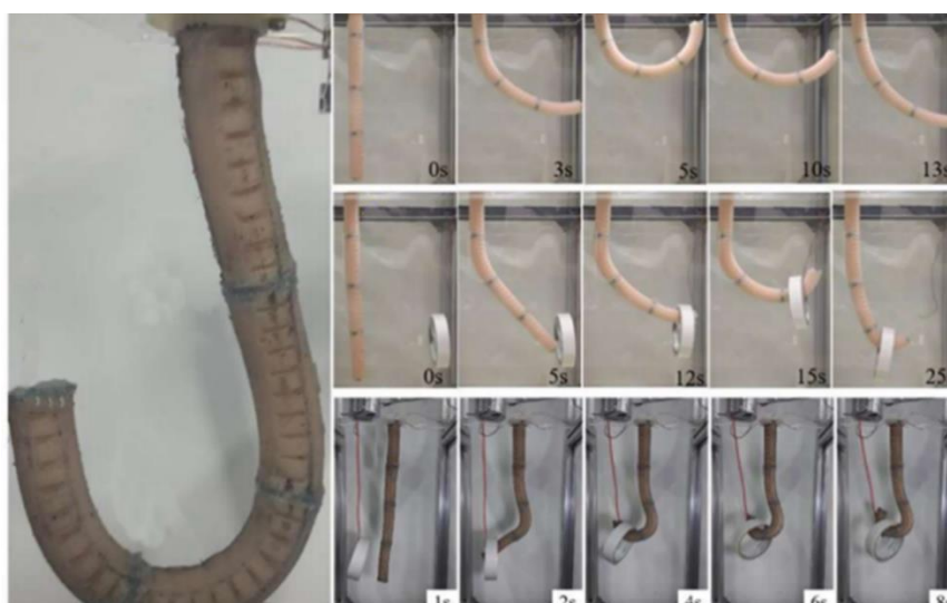
Rysunek 3.5. Ruchomość elastycznego ramienia robota [149]
