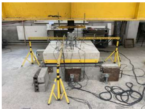
Rysunek 3 Widok stanowiska badawczego dla testów płyt podpartych na gruncie obciążonych centralną siłą skupioną
