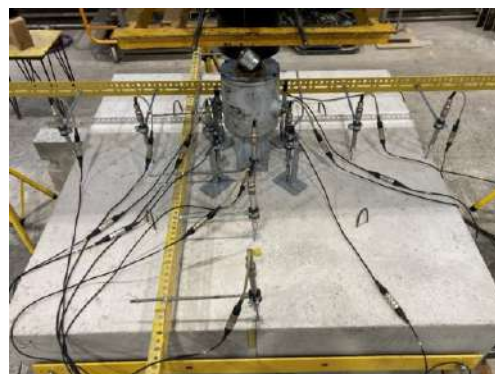
Rysunek 3 Widok stanowiska badawczego dla testów płyt podpartych na gruncie obciążonych centralną siłą skupioną
