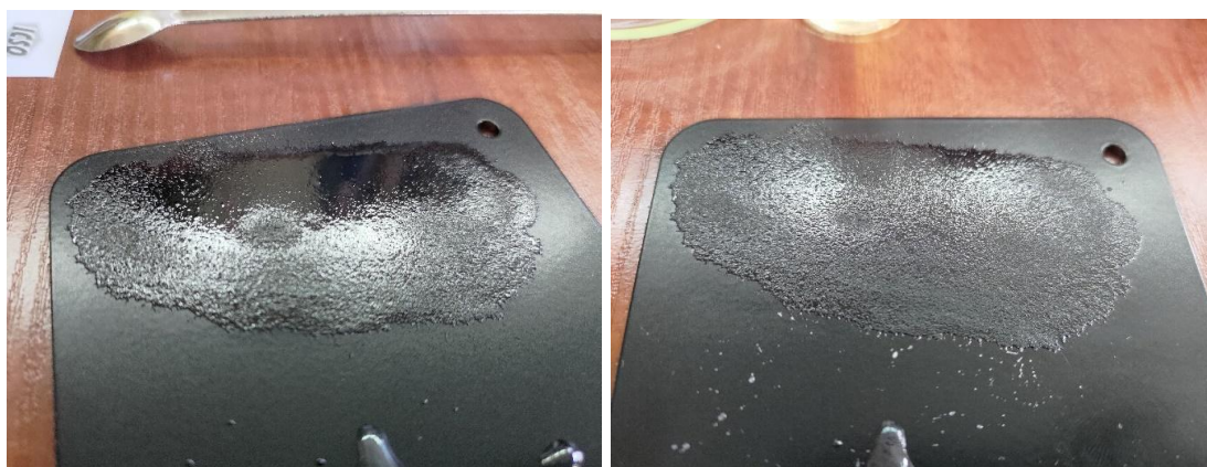
Fot. 15, 16. Powłoka utworzona przez żywicę bezformaldehydową po nałożeniu (a) oraz utwardzeniu (b).
