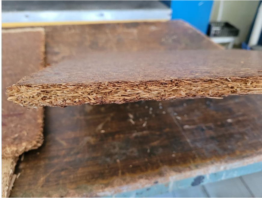
Fot. 10. Płyta wiórowa wytworzona z zastosowaniem żywicy MG22, przekrój poprzeczny
