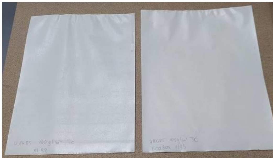
Fot. 12. Papier dekoracyjny pokryty mieszanką zawierającą żywicę melaminowo-formaldehydową (po lewej) oraz mieszanką zawierającą bezformaldehydową żywicę melaminową (po prawej).
