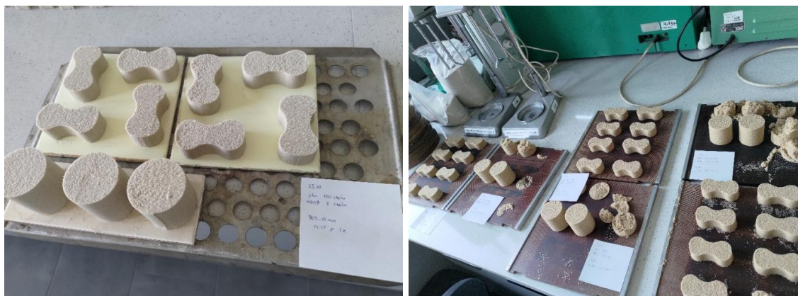
Fot. 18, 19. Kształtki ósemkowe i walcowe wytworzone za pomocą suszarki – wariant I
