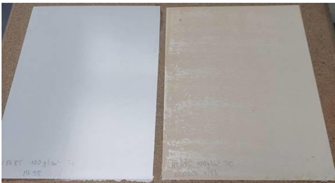
Fot. 13. Papier dekoracyjny pokryty mieszanką zawierającą żywicę melaminowo-formaldehydową (po lewej) oraz mieszanką zawierającą bezformaldehydową żywicę melaminową (po prawej) po zaprasowaniu.
