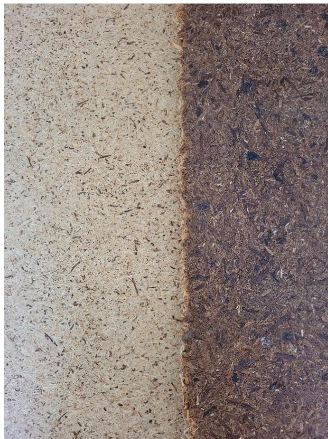
Fot. 11. Porównanie płyty wiórowej wytworzonej z zastosowaniem handlowo dostępnej żywicy MUF z płytą wiórową wytworzoną z zastosowaniem żywicy MG22
