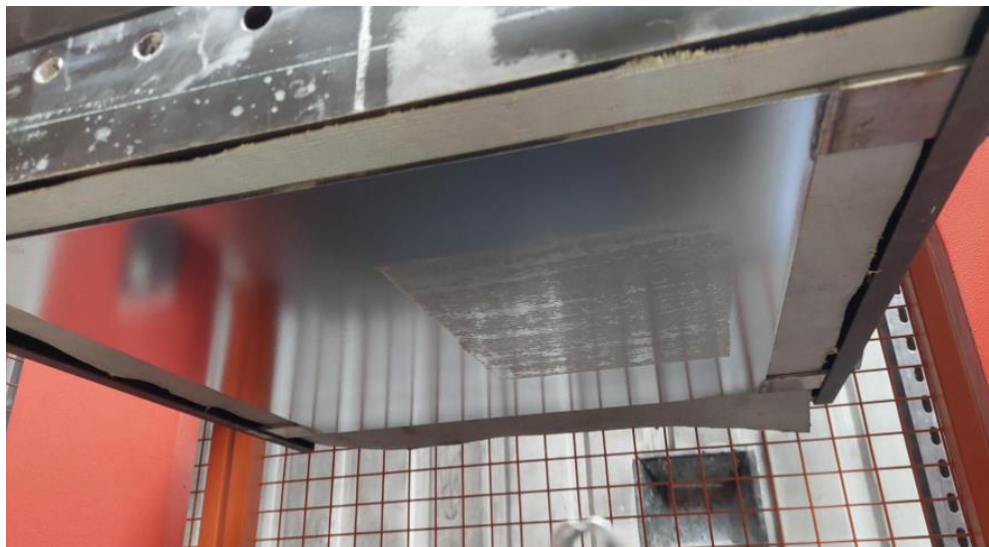
Fot. 14. Ślady pozostawione przez mieszankę zawierającą bezformaldehydową żywicę melaminową.
