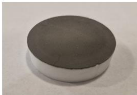
Próbka sprasowana w osłonce z kwasu borowego do postaci pastylki
