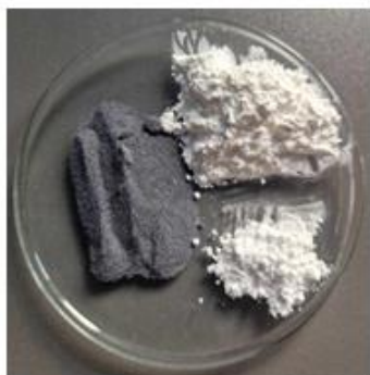
4 g próbki + 1 g Licowax (lepiszcze) + 0,2 g wzorca wewnętrznego \text{SrCO}_3
