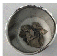
4 g LiB_4O_7 (topnik) + 3 g „skruszonej” próbki – pokrytej pozostałą częścią topnika (3 g) – tygiel platynowy
