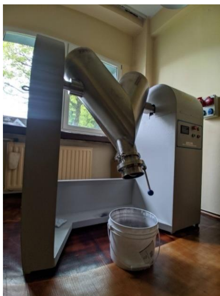
Rys. 5. Mieszalnik typu V do przygotowania mieszaniny FSM o odpowiedniej zawartości magnezu.
