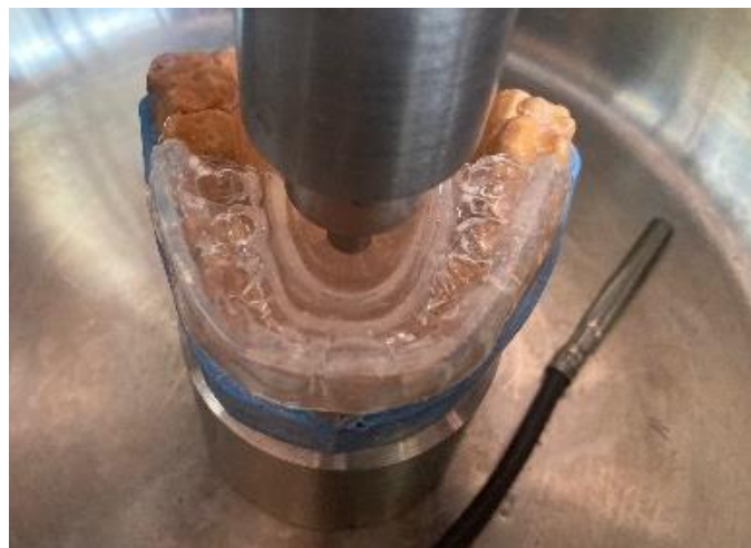
Rysunek 25. Stanowisko do badań sprężystego powrotu kształtu gotowych trenerów (przed zalaniem wodą).
