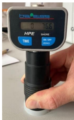
Rysunek 21. Pomiar twardości próbki za pomocą twardościomierza Bareiss HPE II-A.
