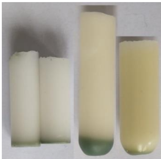
Rysunek 11. Sedymentacja katalizatora wolframowego w mieszaninie poreakcyjnej
