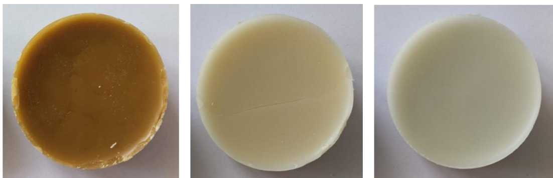
Rysunek 12. Kolor produktu zależnie od ilości rozpuszczalnika (a) brak rozpuszczalnika, b)surowiec:woda 1:3 c) surowiec:woda 1:6)
