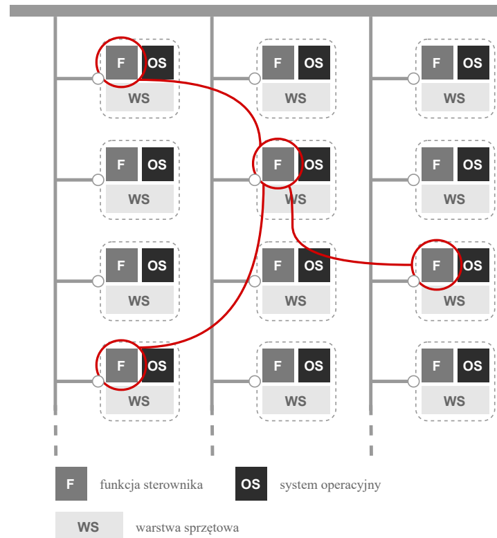
Rysunek 1.3: Wizualizacja zależności pomiędzy realizowanymi funkcjami w pojeździe elektrycznym [25]
