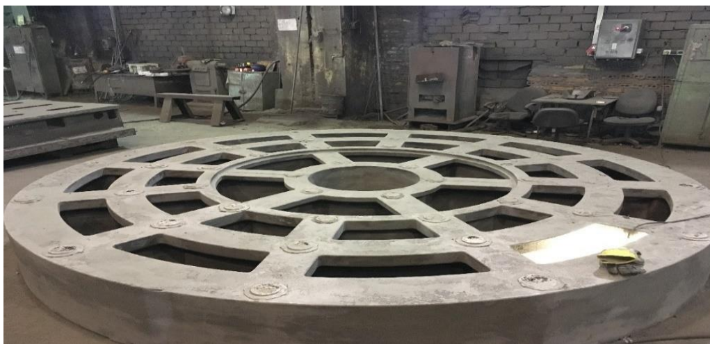
Rys. 112. Odlew stołu z żeliwa sferoidalnego, wytworzony w Odlewni RAFAMET.
