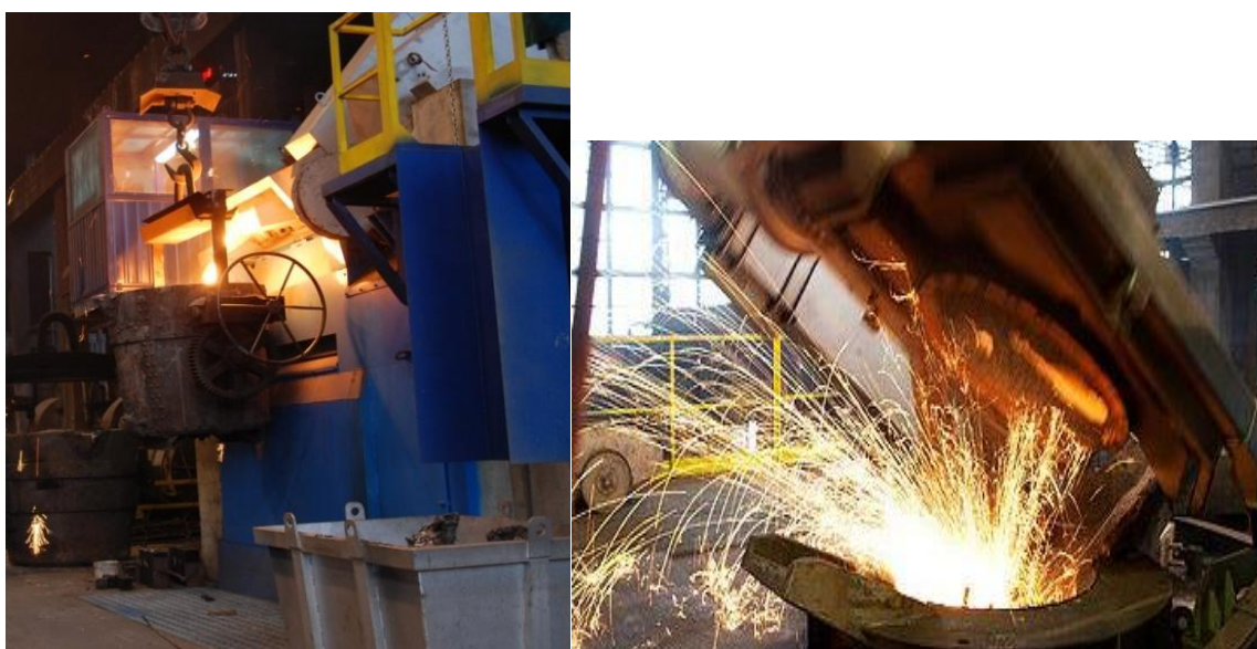
Rys. 7. Spust metalu z pieca indukcyjnego oraz proces topienia w piecu indukcyjnym „Otto Junker”
