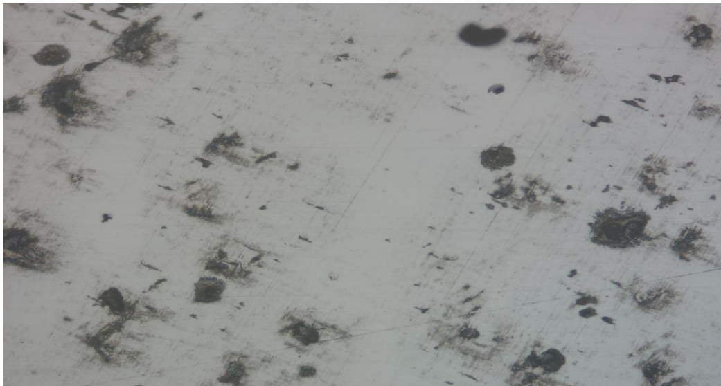
Rys. 89. Mikrostruktura żeliwa gatunku EN-GJS-500-7. Wytop 1
