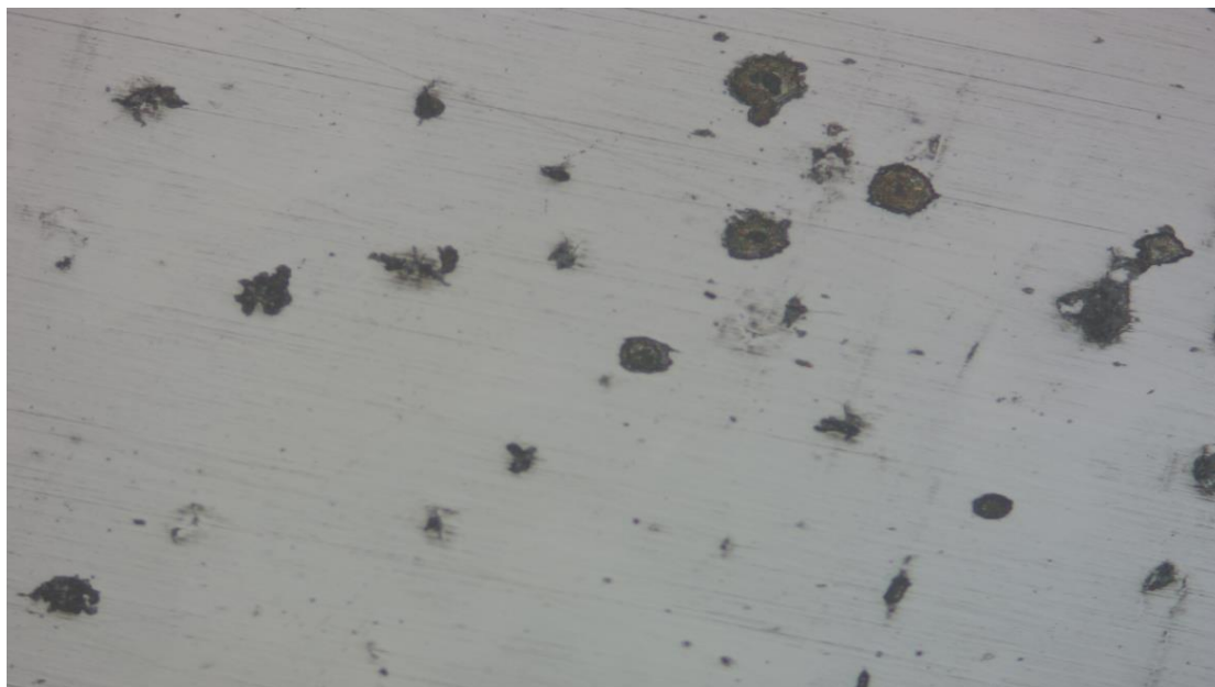
Rys. 90. Mikrostruktura żeliwa gatunku EN-GJS-400-15. Wytop 2.
