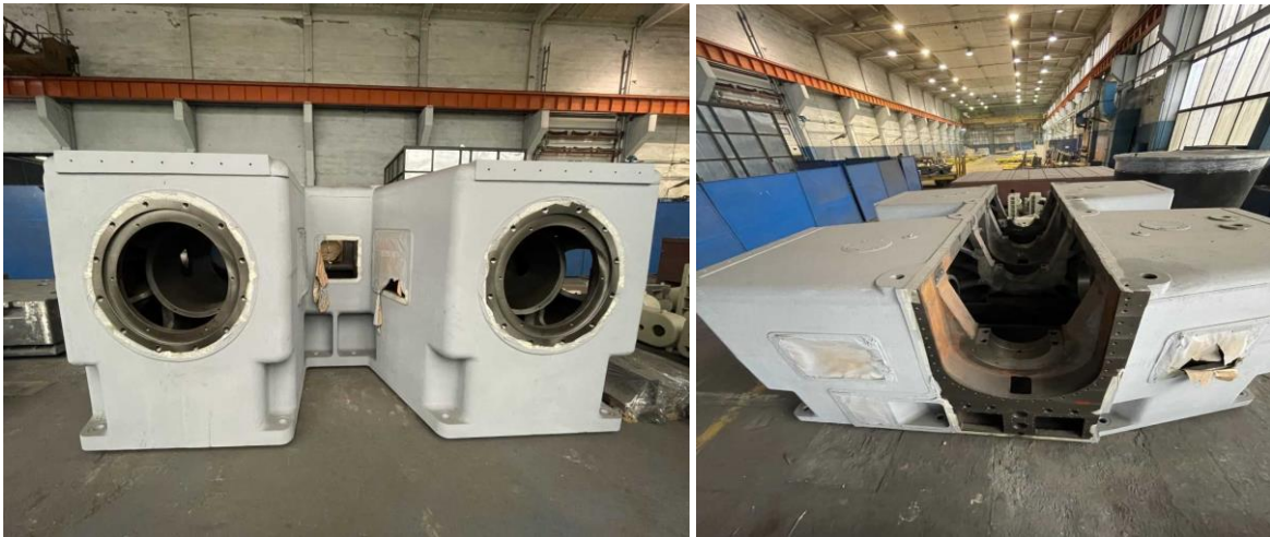
Rys. 116. Odlew obudowy korbowodu z żeliwa sferoidalnego, wytworzony w Odlewni RAFAMET.
