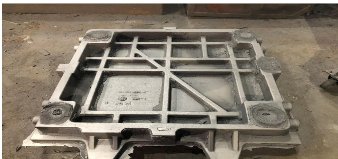
Rys. 77. Przykładowy odlew produkcyjny, charakteryzujący się 4 węzłami cieplnymi w których wystąpiły wady skurczowe
