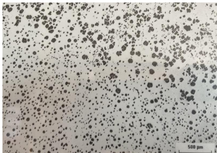
Rys. 33. Przykład flotacji grafitu sferoidalnego w mikrostrukturze żeliwa [17].
