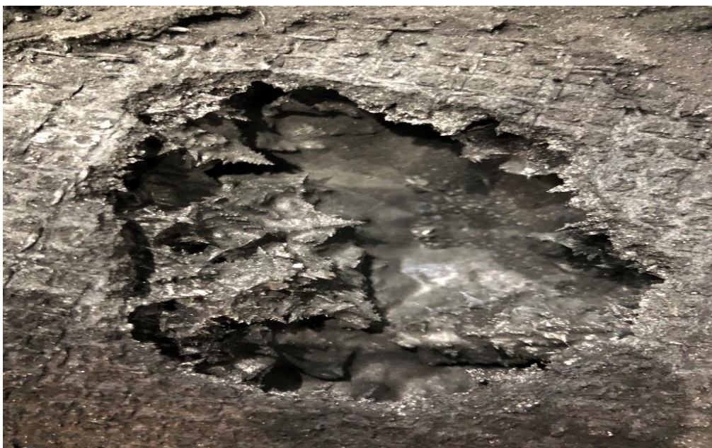
Rys. 78. Jama skurczowa w jednym z węzłów cieplnych
