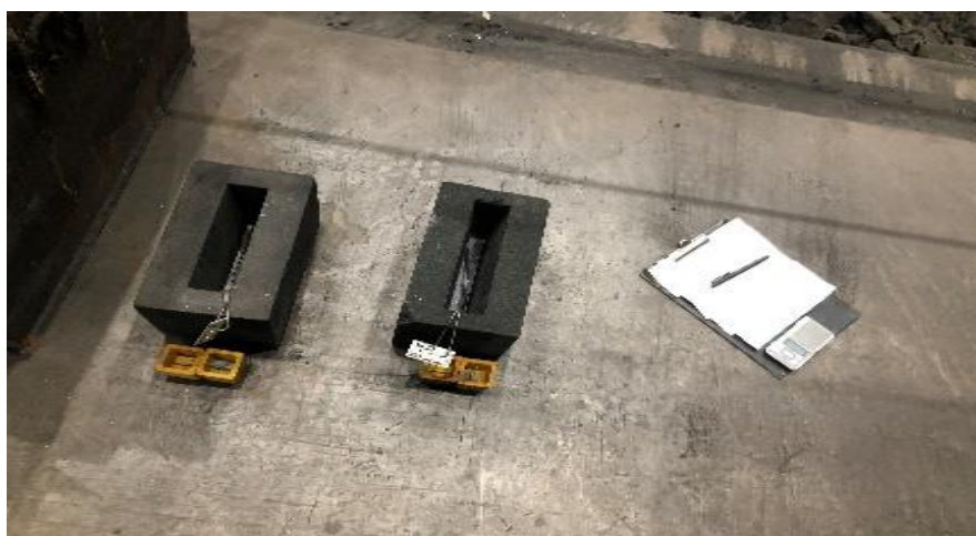
Rys. 40. Formy do zalania próby wytrzymałościowej
