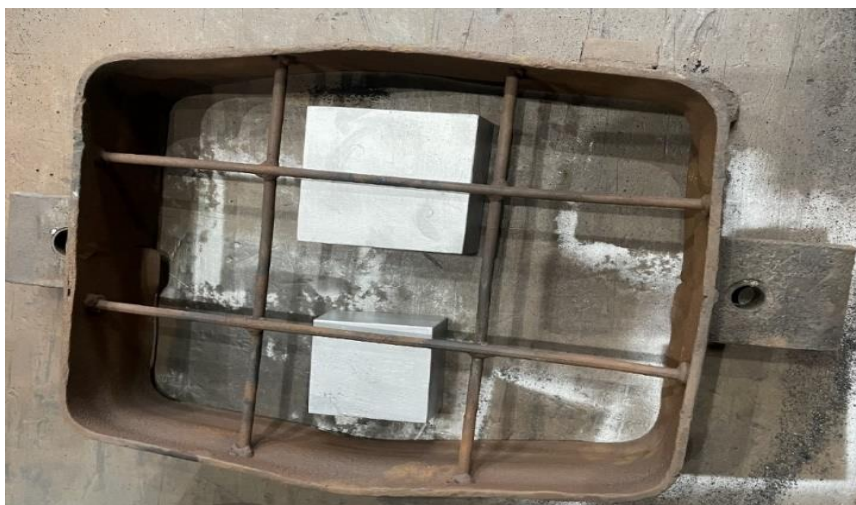
Rys. 87. Rozmieszczenie modeli prób kostek w formie
