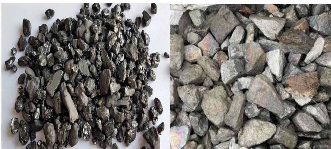
Rys. 5. Dodatki stopowe, po lewej stronie nawęglacz syntetyczny, po prawej żelazokrzem [12].
