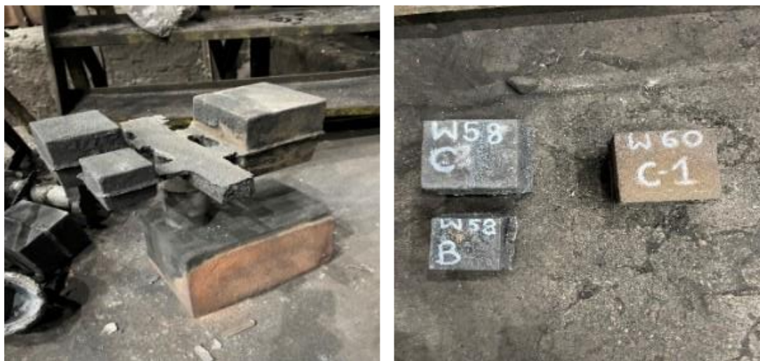
Rys. 83. Odlewy prób kostek, z układem wlewowym, wykonany według założeń symulacji.
