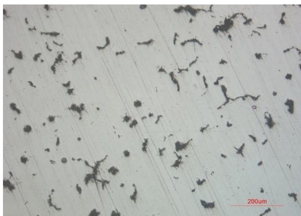
Rys. 96. Mikrostruktury żeliwa gatunku EN-GJS-400-15. Uzyskane z przekrojów prób kostek zalanych podczas wytopu nr 5
