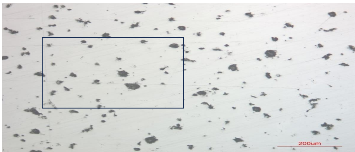
Rys. 107. Obszar do pomiaru gęstości wydzieliń grafitu sferoidalnego, wyznaczony na przykładowym zglądzie.
