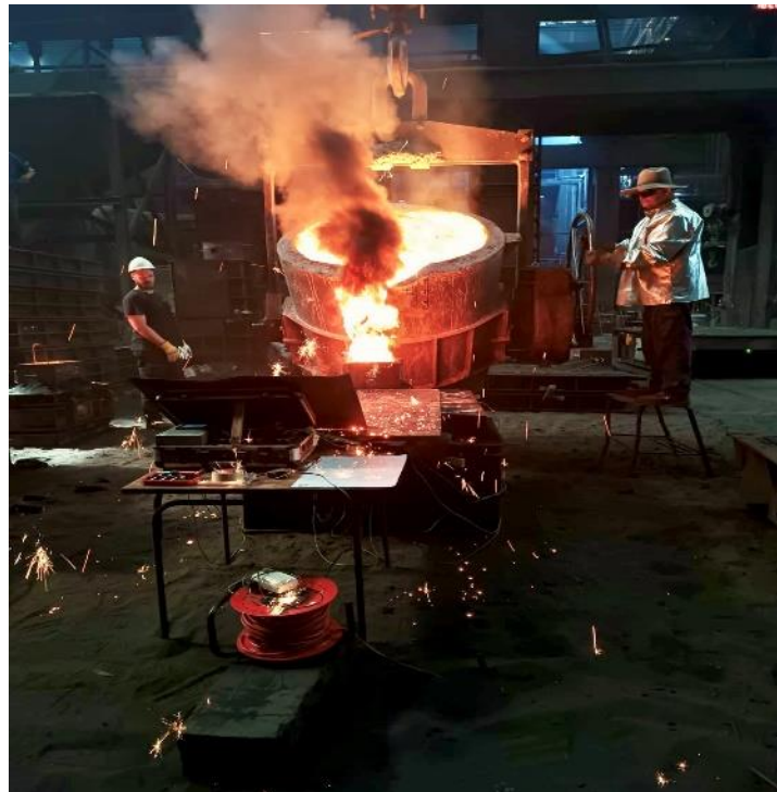
Rys. 80. Zgasowanie modelu podczas zalewania formy z próbnikami do analizy termicznej.
