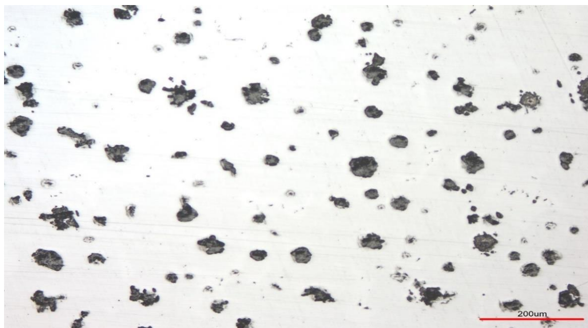
Rys. 95. Mikrostruktura żeliwa gatunku EN-GJS-500-7. Wytop 4
