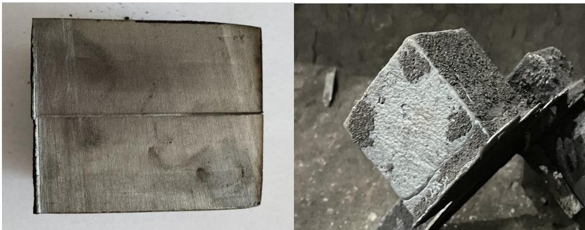
Rys. 105. Wyniki tomografii komputerowej uzyskane dla odlewów z żeliwa EN-GJS-500-7, z wytopu 8, bez dodatkowej modyfikacji, w zestawieniu z przekrojem brył tych samych odlewów w celu analizy wad powierzchniowych widocznych na wynikach tomografii,
