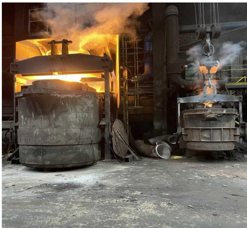
Rys.113. Proces sferoidyzacji metalu, przed zalaniem stołu.
