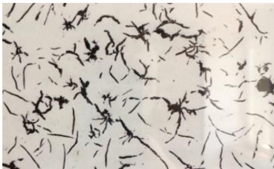
Rys. 31. Grafit typu „C” w strukturze żeliwa [17].
