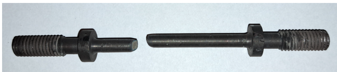
Rysunek 74. Zerwana próbka złącza ze stali X10CrWMoVNB9-2 po próbie pełzania w temperaturze 600°C i naprężeniu rozciągającym 120 MPa
