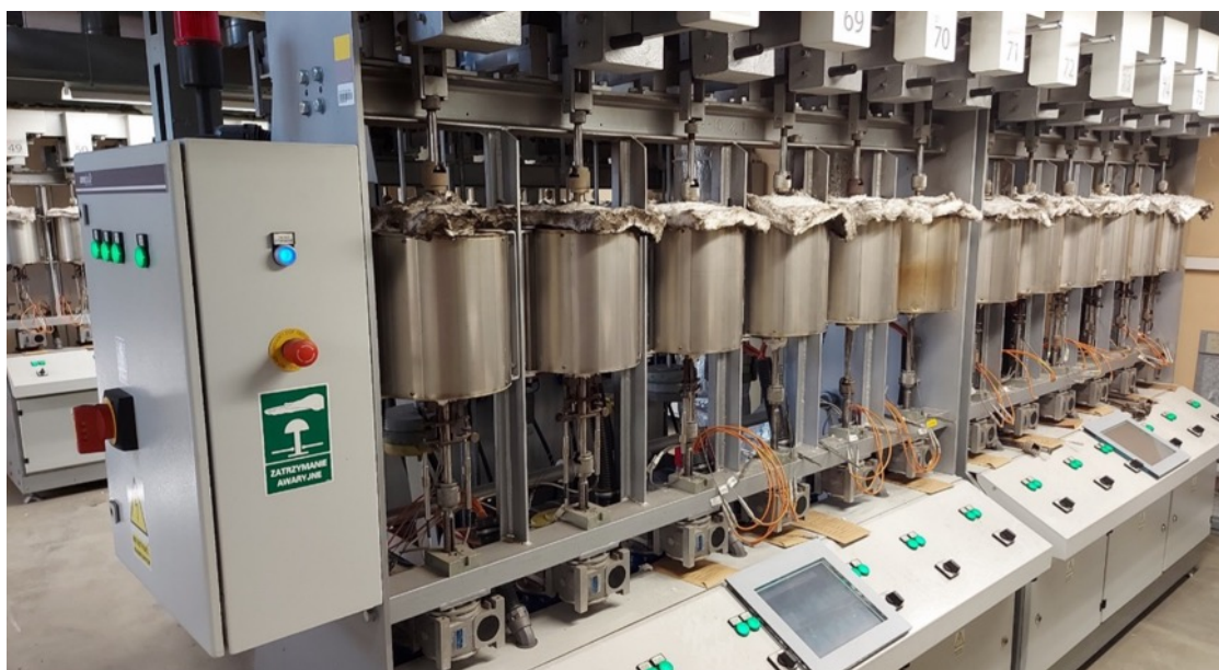
Rysunek 31. Maszyny do prób pełzania Sieci Badawczej Łukasiewicz - Górnośląskiego Instytutu Technologicznego w Gliwicach
