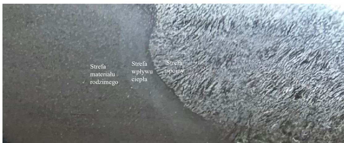
Rysunek 34. Schemat obserwacji mikrostruktury badanego złącza spawanego
