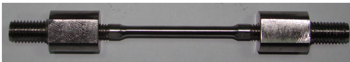
Rysunek 32. Próbka do badań pełzaniowych zamontowana w uchwytach
