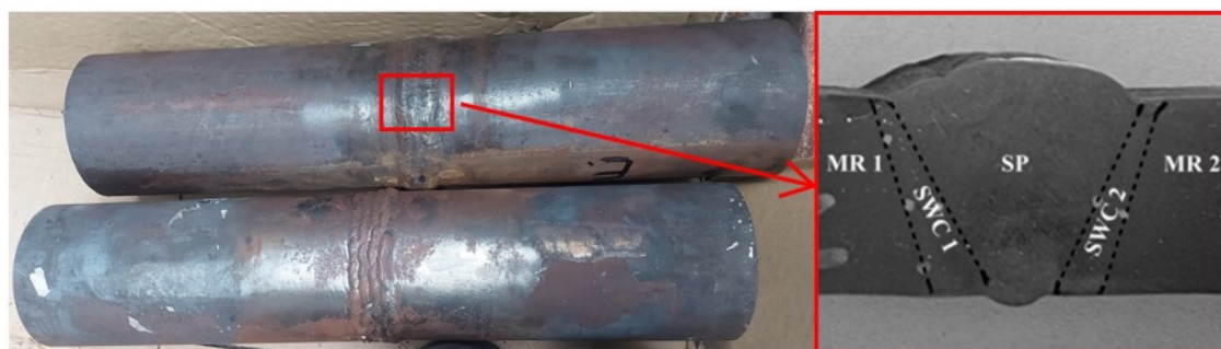
Rysunek 28. Próbka do badań pobrana z rurowego złącza spawanego
