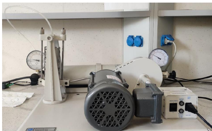
Rysunek 39. Reaktor firmy Parr, w którym przeprowadzano redukcję katalityczną.
