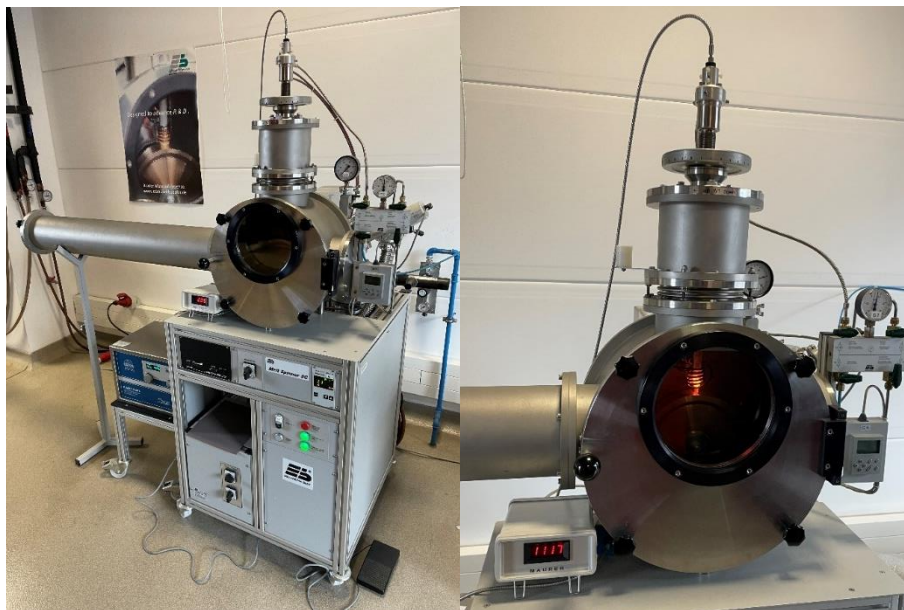
Rysunek 20. Stanowisko do wytwarzania taśm metodą przedzenia ze stopu, Bühler Melt Spinner SC
