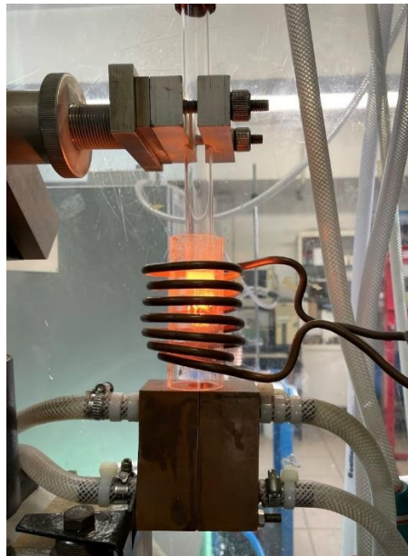
Rysunek 22. Stanowisko wytwarzania stopów w postaci płytek metodą odlewania wysokociśnieniowego do formy miedzianej
