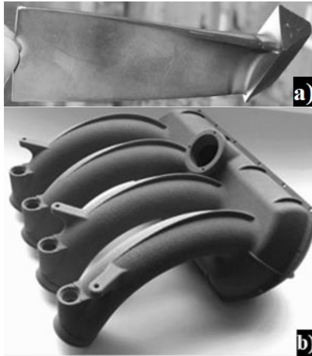
Rysunek 16. Przykłady zastosowań stopów o złożonej strukturze na bazie aluminium: a) łopatką turbiny silnika helikoptera z warstwą ochronną 0,3 mm wytworzoną ze stopu AlCoFeCr (CMAs), b) kolektor dolotowy kompozytowy, wzmacniany cząstkami AlCuFeB (CMAs) wykonany w technologii SLS, na podstawie [39,40,165]
