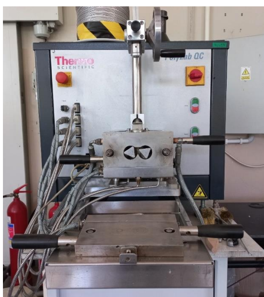
Rys. 32 Mieszalnik periodyczny firmy HAAKE™ PolyLab™ QC wykorzystywany do przygotowania kompozytów PVC.
