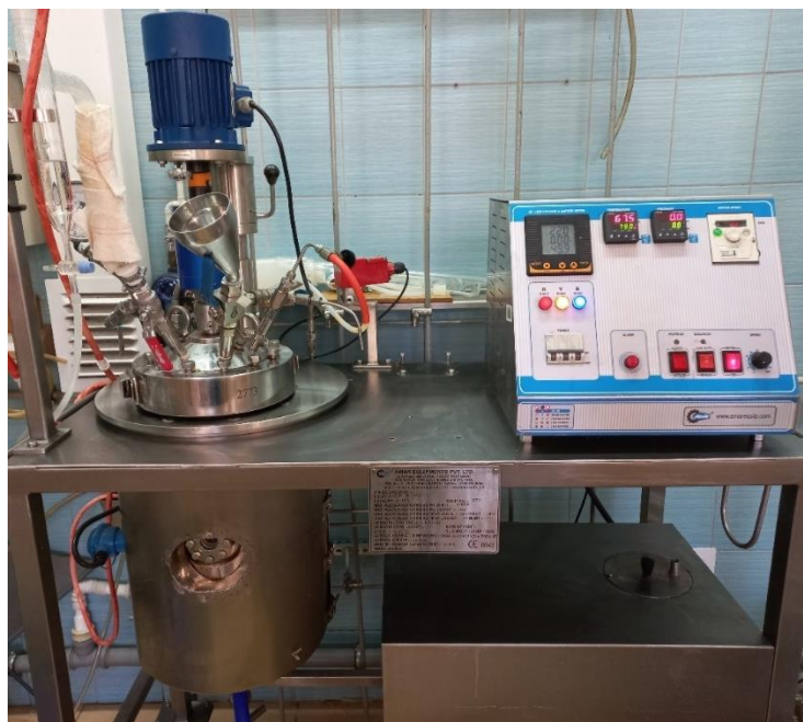
Rys. 31 Zestaw wykorzystywany w procesie estryfikacji i epoksydacji w skali wielolaboratoryjnej, na zdjęciu reaktor ze stali kwasoodpornej o pojemności 15 dm 3 .
