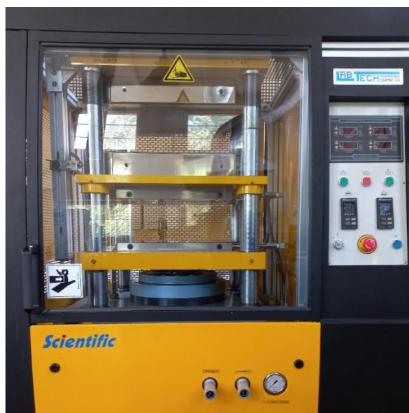
Rys. 33 Prasa hydrauliczna typ LP-S-50 firmy Labtech Engineering Co. wykorzystywana do prasowania żelowanych próbek PVC.
