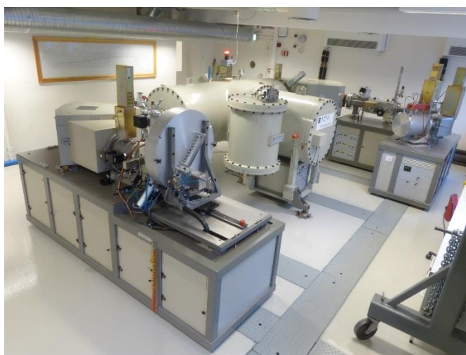
Rys. 2 Akceleratorowy spektrometr masowy w Narodowym Laboratorium Określania Wieku w Trondheim w Norwegii.
