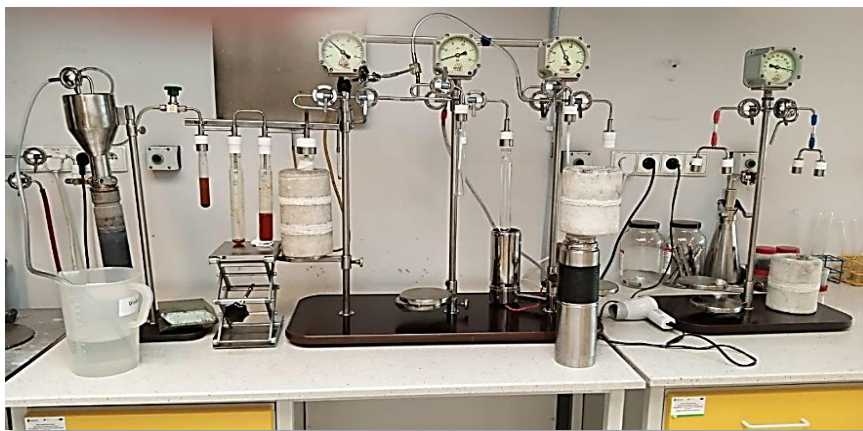
Rys. 3 Linia do syntezy benzenu w Laboratorium ^{14}C i Spektrometrii Mas w Gliwicach.
