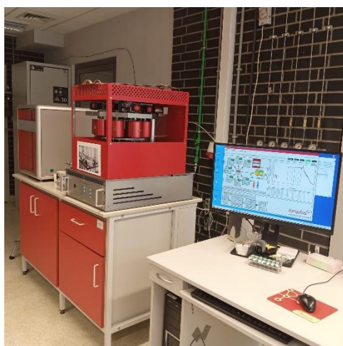
Rys. 1a Analizator elementarny sprzężony z automatycznym systemem grafityzacji w Laboratorium 14 C i Spektrometrii Mas w Gliwicach.
