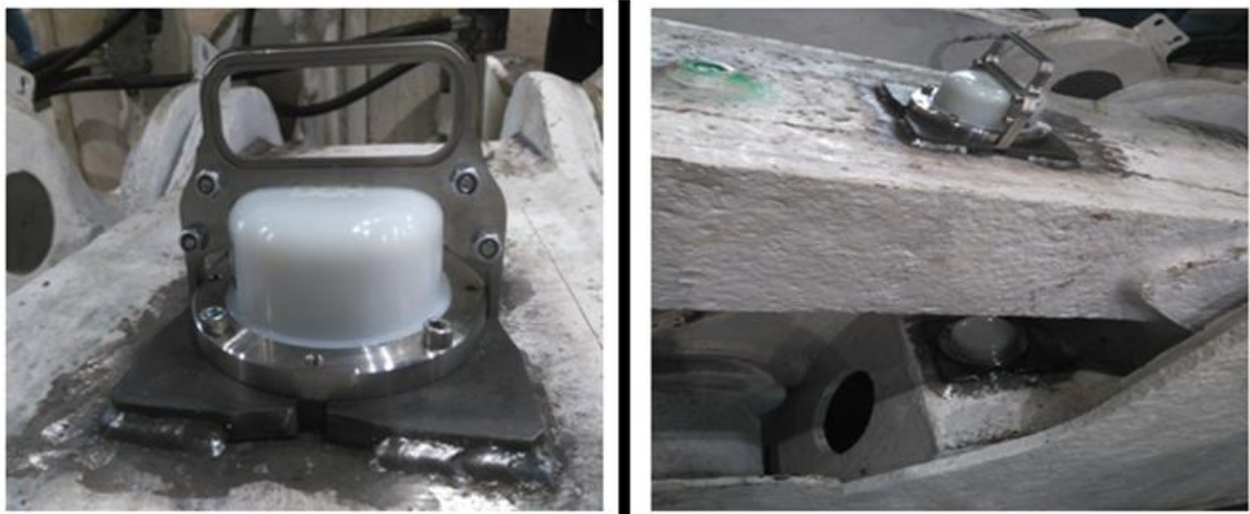
Rys. 9.6. Ręczna kalibracja czujnika za pomocą specjalistycznego przyrządu
