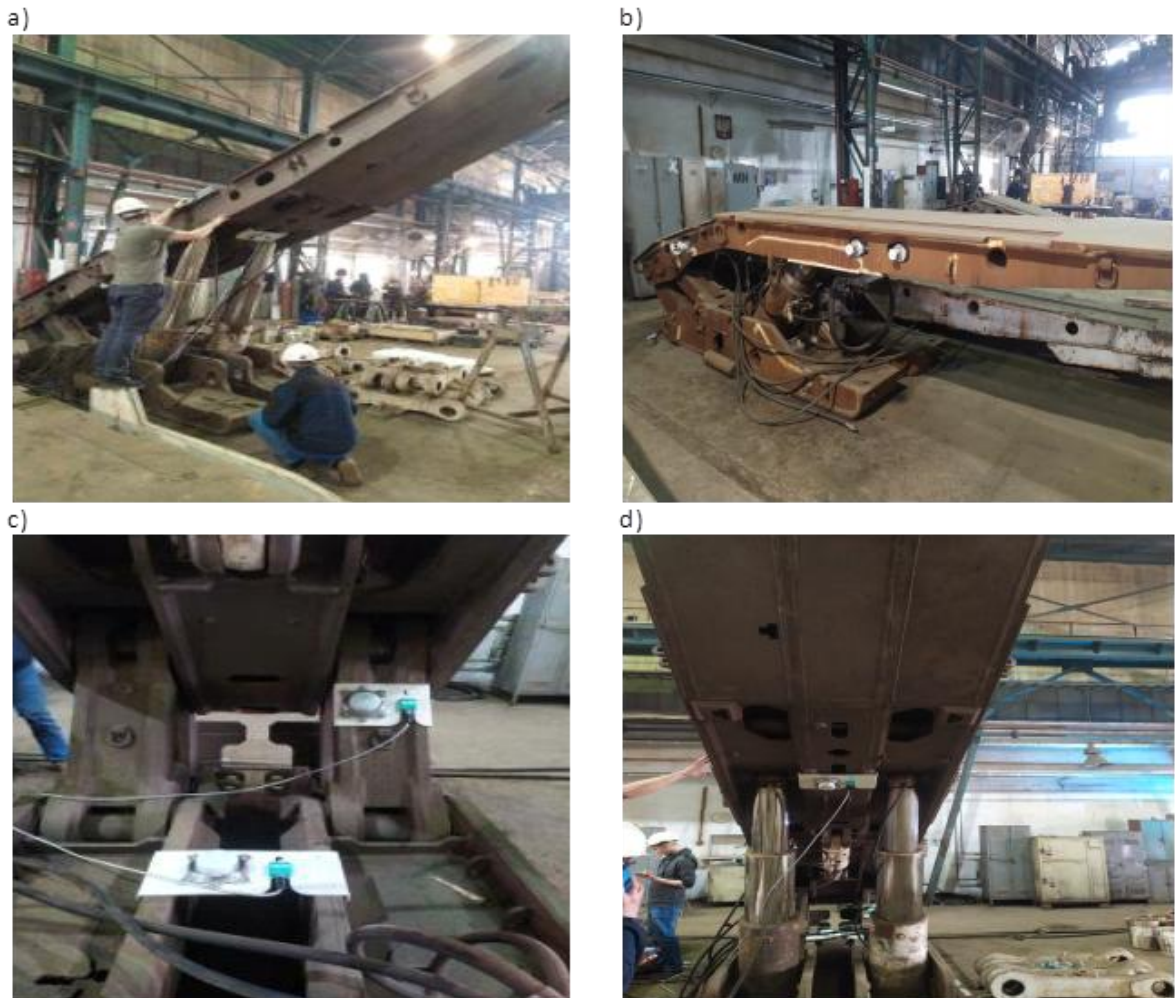
Rys. 7.9. Widok stanowiska badawczego, gdzie: sposób pomiaru wysokości i nachylenia stropnicy (a), sposób pomiaru minimalnego zakresu pracy obudowy (b), lokalizacja prototypu czujników (spągница, łącznik przedni) (c), lokalizacja prototypu czujnika stropnicy (d)
