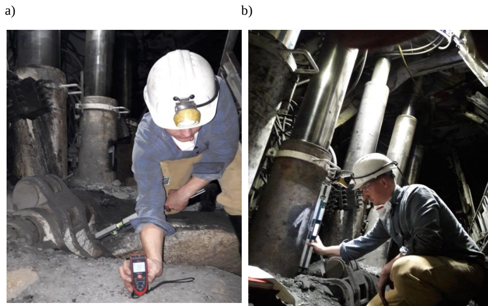
Rys. 8.3. Pomiary ręczne geometrii rozparcia obudowy, gdzie: pomiar wysokości –urządzeniem Dalmierz laserowy LeicaDisto D2 (a), pomiar nachylenie stojaka –urządzeniem BOCH Professional GIM 60 (b)
