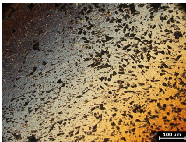
Rysunek 5. 22. Iglaste wydzielenia krzemu w strefie wpływu ciepła (prędkość obrotowa 1400, posuw 50, powiększenie 200x).
