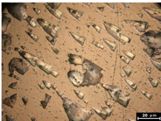
Rysunek 5. 28. Iglaste wydzielenia krzemu oraz innych pierwiastków (prędkość obrotowa 1200, posuw 50, powiększenie 1000x).
