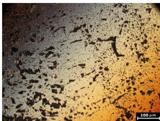
Rysunek 5. 27. Rozrost ziaren i wydzieleni w strefie wpływu ciepła (prędkość 1200, posuw 50, powiększenie 200x).
