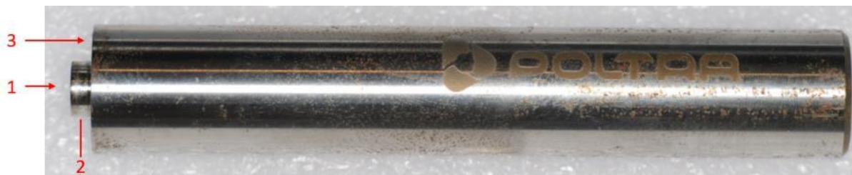
Rysunek 4. 9. Schemat badania twardości części roboczej narzędzia FSW.
