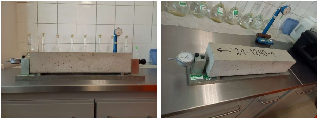
Rys. 47. Pomiar skurczu betonu metodą Amslera
