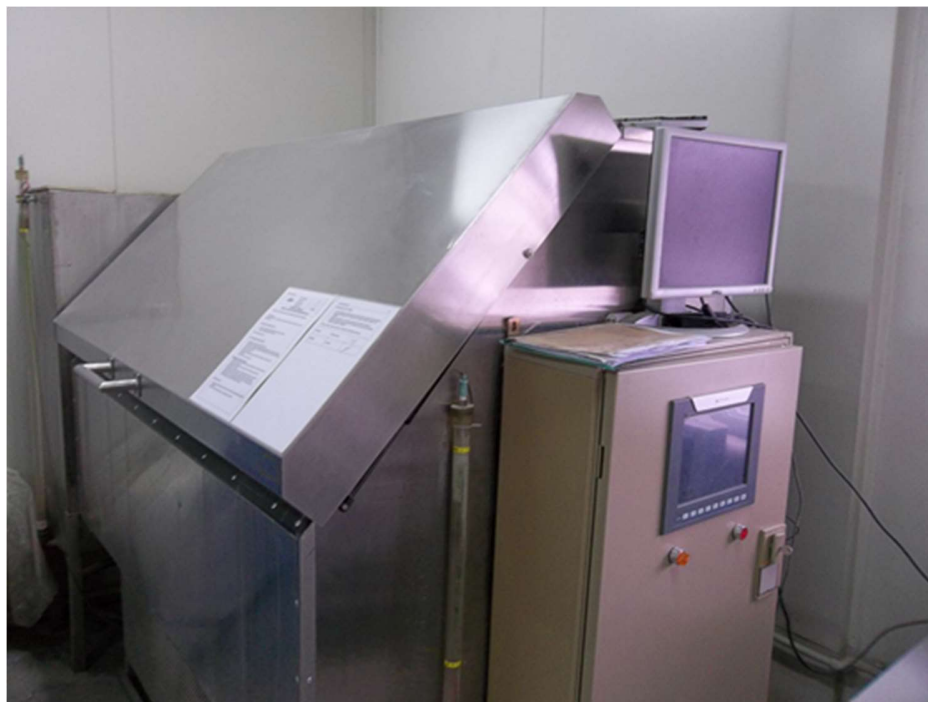
Rys. 58. Automatyczna komora zamrażalnicza do badania mrozoodporności betonu
