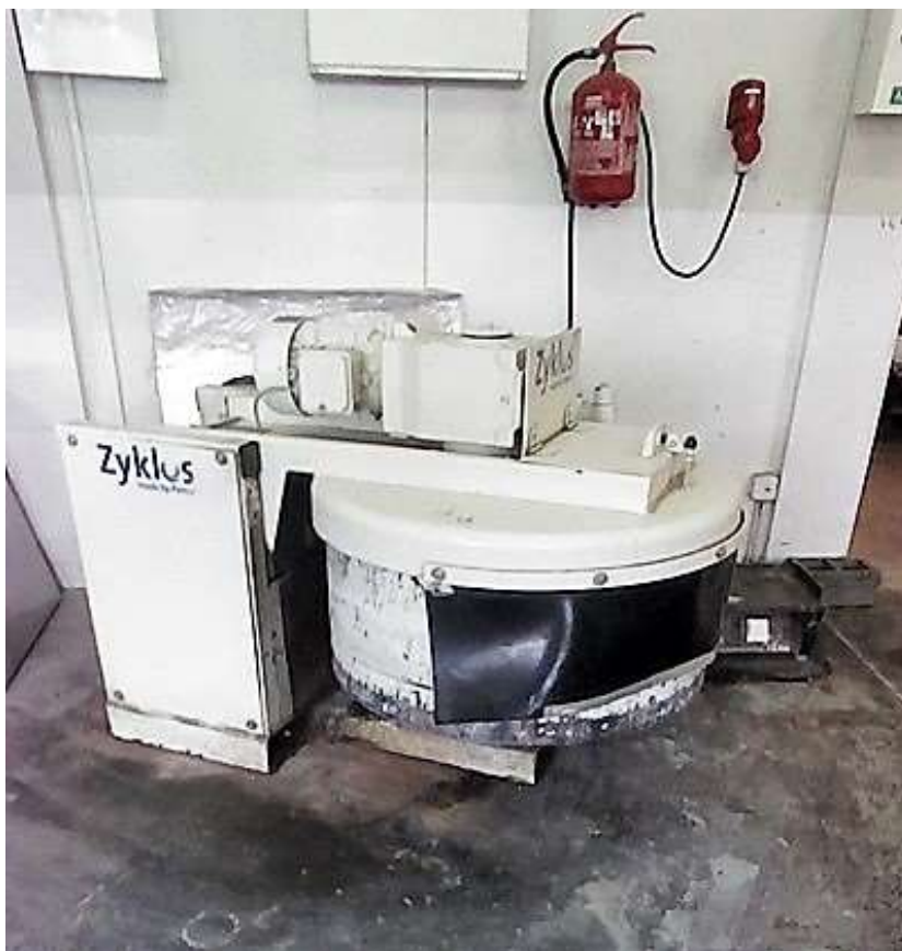
Rys. 40. Laboratoryjny mieszalnik betonu typu Pemat Zyklus
