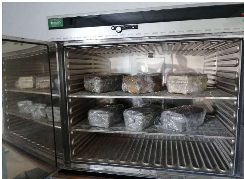
Rys. 54. Symulacja procesu naporzania niskoprężnego w suszarce firmy Memmert
