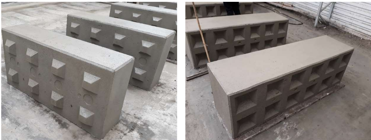
Rys. 12. Widok betonowych elementów prefabrykowanych wykonanych za pomocą wibroprasy kroczącej [materiały własne]
