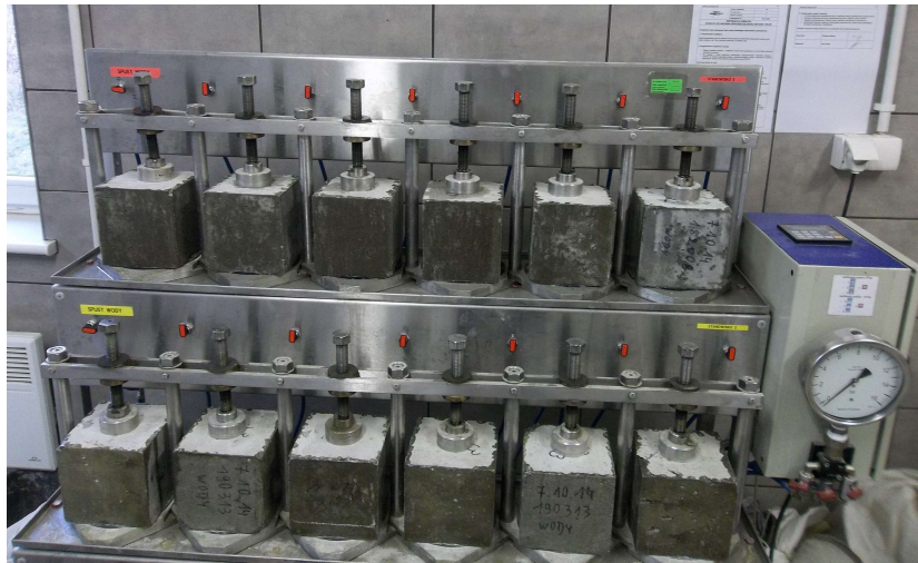
Rys. 46. Stanowisko badawcze do badania głębokości penetracji wody pod ciśnieniem
