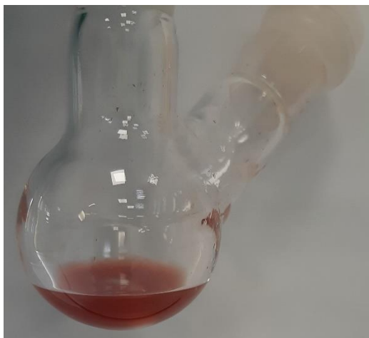
Rysunek 13 Mieszanina reakcyjna po dodaniu do układu 2-etyloheksanianu sodu
