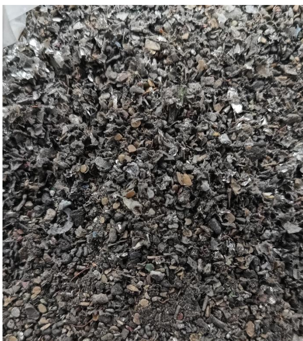
Rysunek 31. Widok frakcji płytek PCB wykorzystanej w laboratoryjnych badaniach redukcji żużla.
