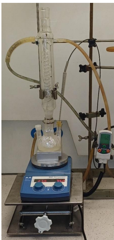
Rysunek 25. Aparatura do syntezy węglanu dimetylu metodą transestryfikacji PC metanolem.
