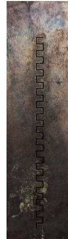
Rys. 7.2 Widok próbek wycinanych w ramach badań eksperymentalnych, na których przeprowadzono a) pomiary chropowatości powierzchni oraz b) szerokości szczeliny erozyjnej
