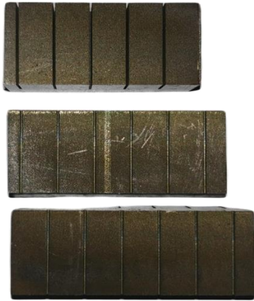
Rys. 7.2 Widok próbek wycinanych w ramach badań eksperymentalnych, na których przeprowadzono a) pomiary chropowatości powierzchni oraz b) szerokości szczeliny erozyjnej
