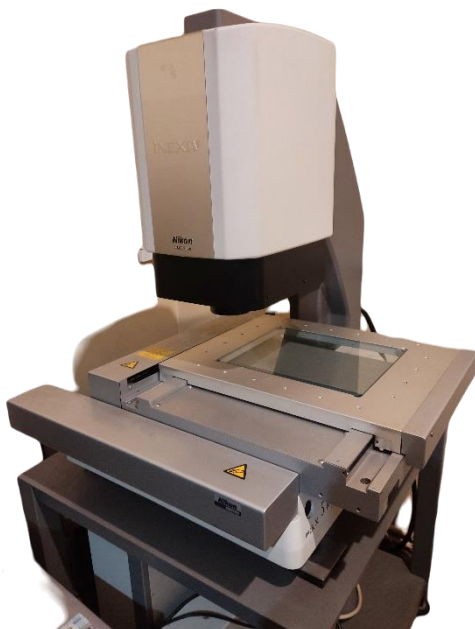
Rys. 7.4 Mikroskopy współrzędnościowe Nikon iNEXIV VMA-2520 a) i KEYENCE IM b)
