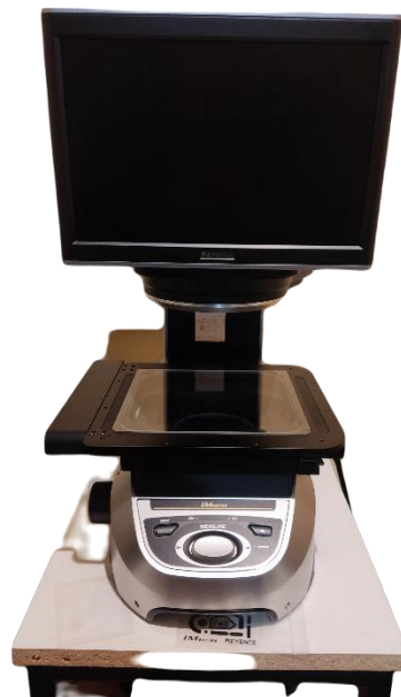
Rys. 7.4 Mikroskopy współrzędnościowe Nikon iNEXIV VMA-2520 a) i KEYENCE IM b)
