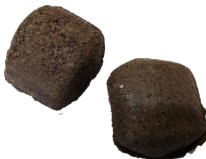
Rys. 50. Morfologia bryketu otrzymywanego po prasowaniu mieszanki głównych substratów z lepiszczem za pomocą pilotowej prasy walcowej
