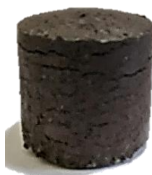
Rys. 49. Morfologia bryketu otrzymywanego po prasowaniu mieszanki głównych substratów z lepiszczem za pomocą prasy laboratoryjnej
