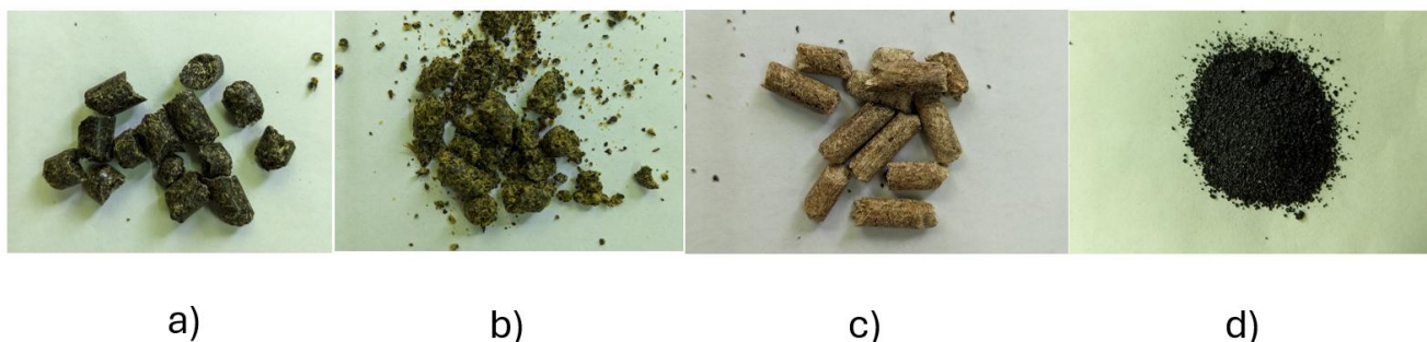
Rys. 9. Różne rodzaje biomasy a) pellet z łusek słonecznika, b) makuch rzepakowy (odpad z produkcji oleju rzepakowego), c) pellet z odpadów tartacznych, d) karbonizat po pirolizie łupin orzecha włoskiego
