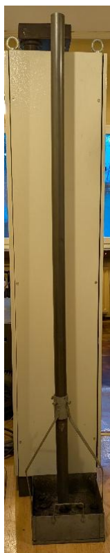
Rys. 27. Stanowisko do oceny wytrzymałości aglomeratów na zrzut
