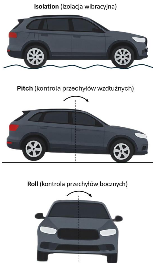
Rysunek 3.2.1.3. Ilustracja podstawowych kierunków ruchu nadwozia: pionowy (isolation), przód–tył (pitch), boczny (roll) [1W]
