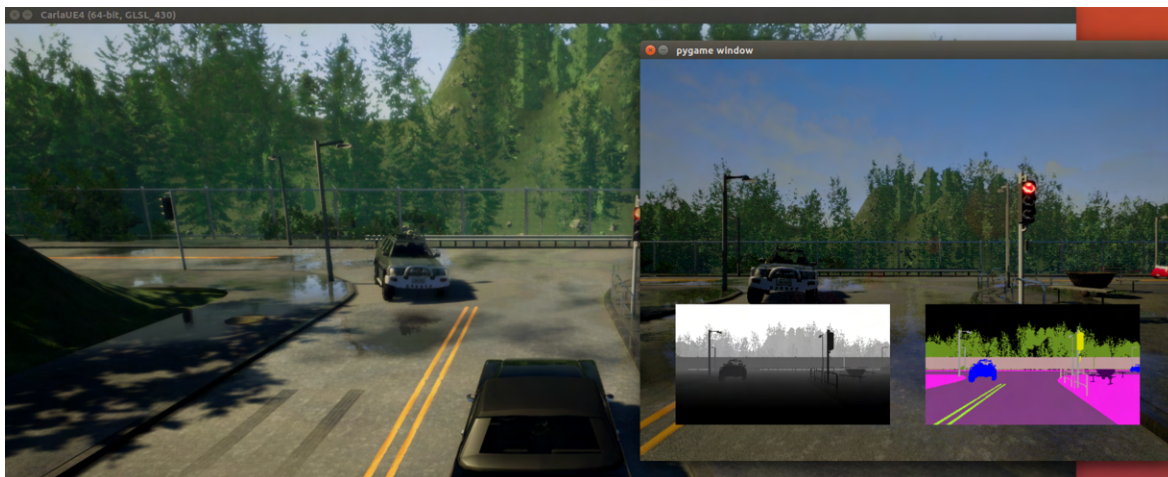
Rysunek 3.2: Symulator Carla wraz z podglądem wirtualnych kamer głębi i segmentacji [97].
