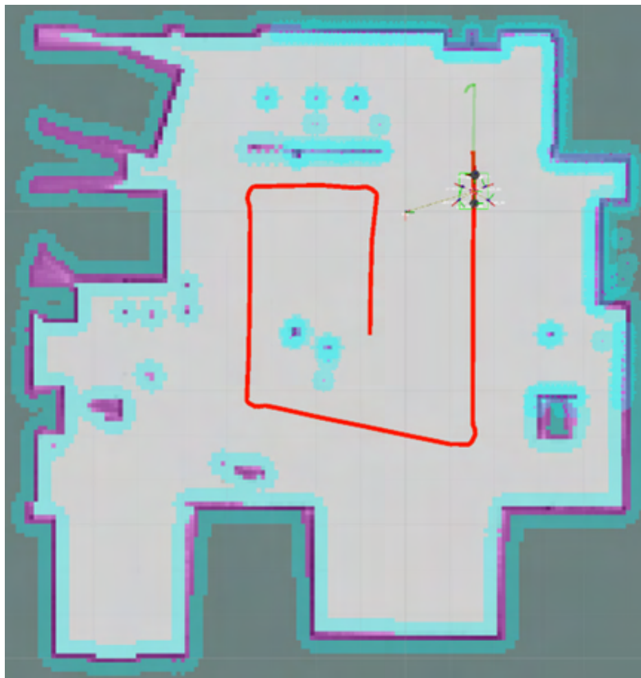
Rysunek 5.17: Mapa przeszkód pomieszczenia laboratoryjnego wygenerowana na podstawie danych z WST wraz z predefiniowaną trasą przejazdu oraz dodatkową warstwą wizualizacji mapy.
