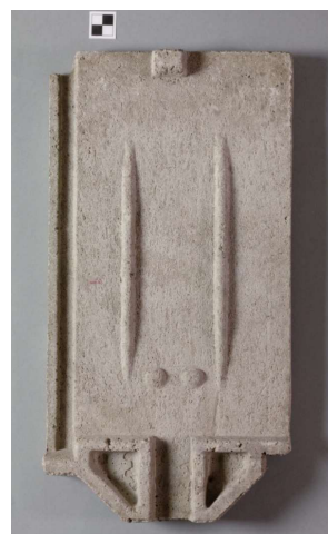
Rys. 6-10. Cementowa dachówka zakładkowa z pojedynczym wąskim żłobieniem przy krawędzi ze ściętą dolną krawędzią (typ 5)
