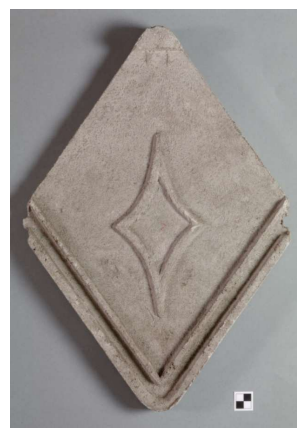
Rys. 6-9. Cementowa romboidalna dachówka płaska o lekko zaokrąglonych narożnikach (typ 4)
