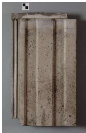
Rys. 6-8. Cementowa zakładkowa dachówka marsylska (typ 3) o wyrazistym, nieco kanciastym podwójnym żłobieniu.
