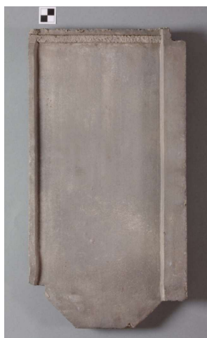
Rys. 6-10. Cementowa dachówka zakładkowa z pojedynczym wąskim żłobieniem przy krawędzi ze ściętą dolną krawędzią (typ 5)
