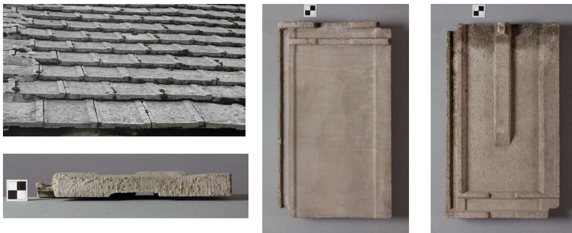
Rys. 6-5. Cementowa dachówka zakładkowa z pojedynczym wąskim żłobieniem przy krawędzi (typ 1a)
