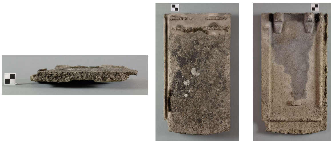
Rys. 6-6. Cementowa zakładkowa dachówka płaska bez żłobienia (typ 1b)
