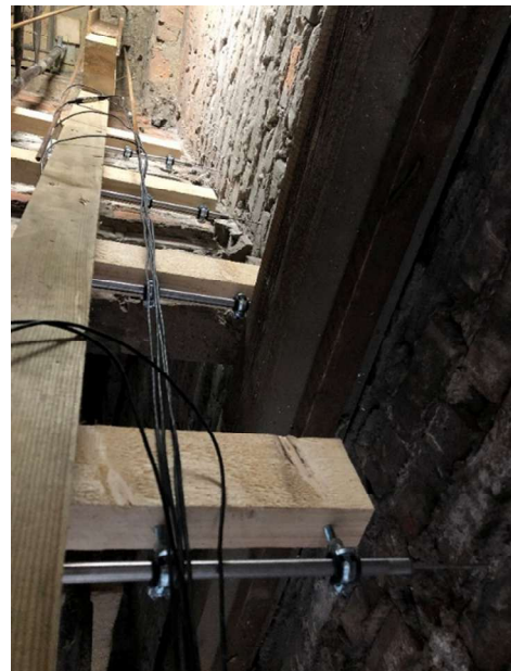
Rys. 9-6. Czujniki zabudowane na ścianie: a) układ siłownik – siłomierz elektrooporowy za pomocą którego realizowano pomiary sił Q_i , b) indukcyjne czujniki przemieszczeń zamocowane do niezależnej konstrukcji wewnątrz baraku, nie związanej z konstrukcją oporową ani ze ścianą, mierzące przemieszczenia u_{wall,i}
