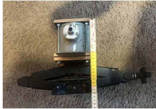
Rys. 9-4. Układ podnośnik – siłomierz: a) szkic, b) fotografia przedstawiająca minimalny wysuw siłownika
