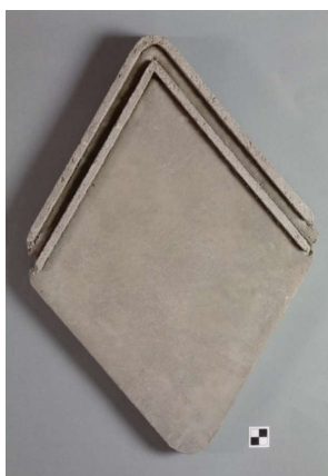
Rys. 6-9. Cementowa romboidalna dachówka płaska o lekko zaokrąglonych narożnikach (typ 4)
