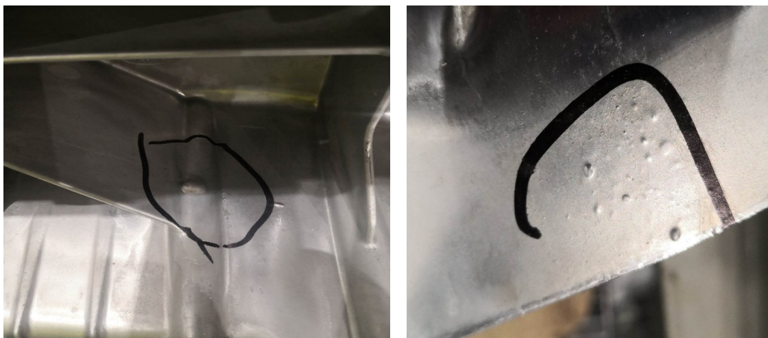
Rys.2.36. Odlewy JLR z pęcherzami gazowymi poza specyfikacją klienta.
