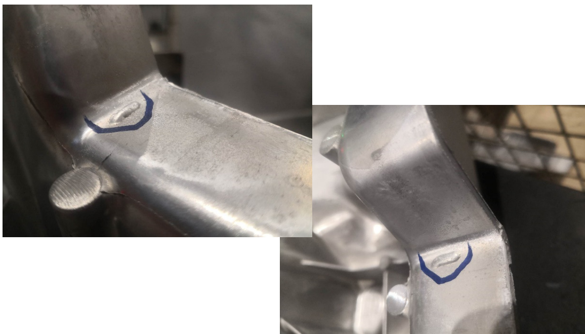
Rys.2.35. Odlewy PP z pęcherzami gazowymi poza specyfikacją klienta.
