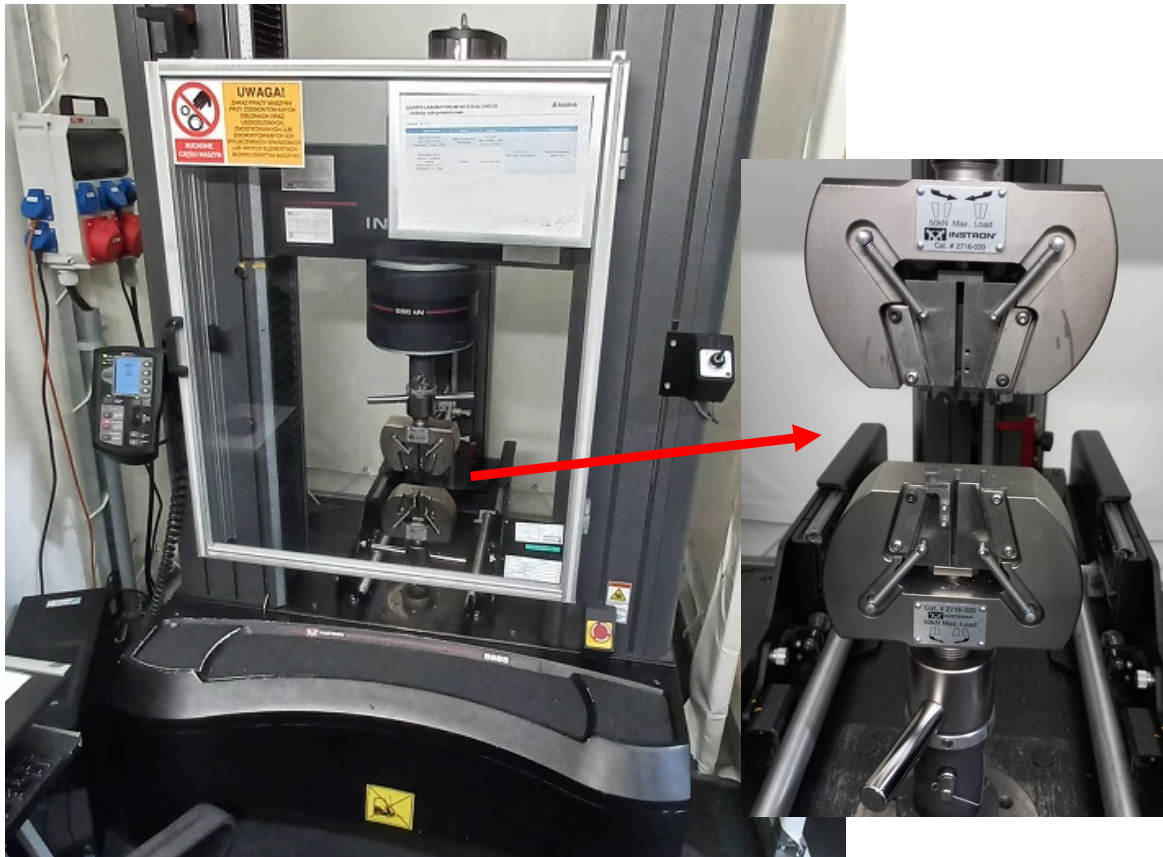
Rys.2.27. Maszyna Instron do badań wytrzymałościowych i uchwyt do próbek w spółce MCP.
