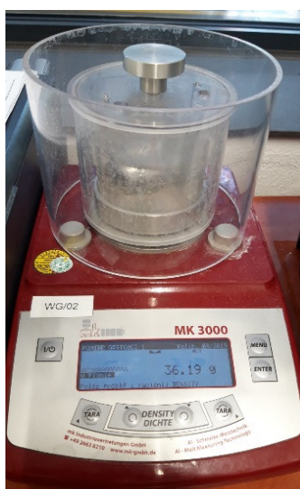
Rys.2.8. Waga do wyznaczania indeksu gęstości stopów aluminium w spółce MCP.
