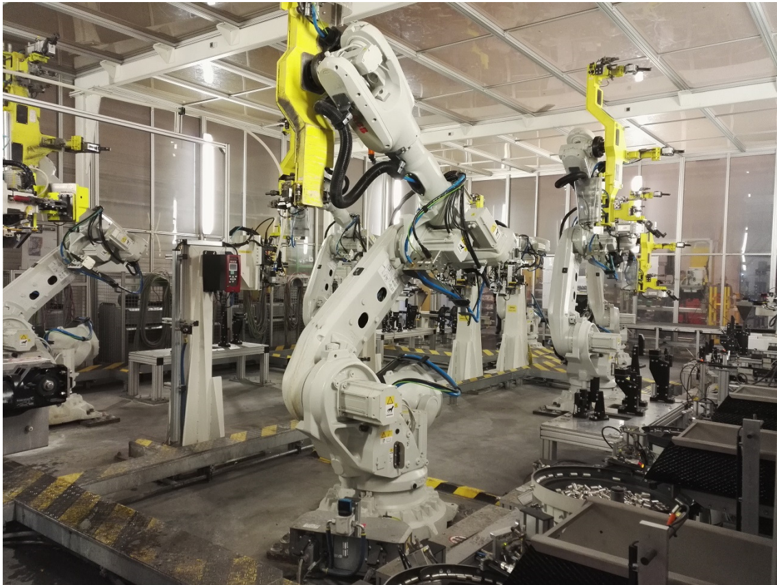
Rys.2.24. Cella montażu komponentów podłużnicy tylnej w spółce MCP.
