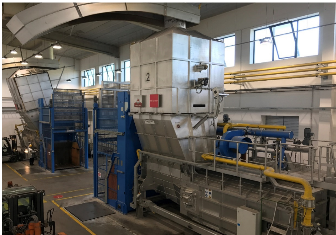
Rys.2.6. Piec topialny Striko MH 6000/3500 w spółce MCP.
