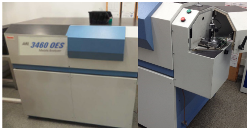
Rys.2.25. Spektrometr iskrowy będący na wyposażeniu spółki MCP.
