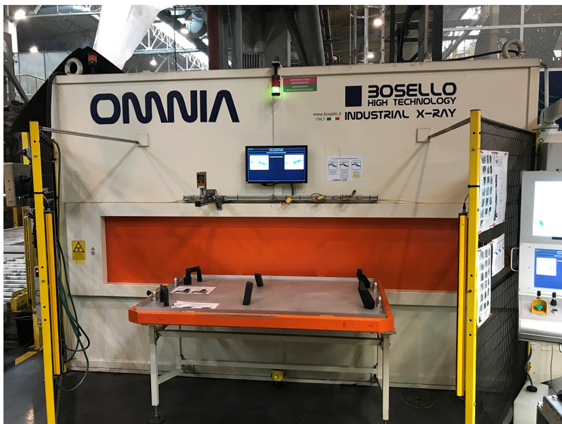
Rys.2.26. Stanowisko do automatycznej kontroli RTG w spółce MCP.
