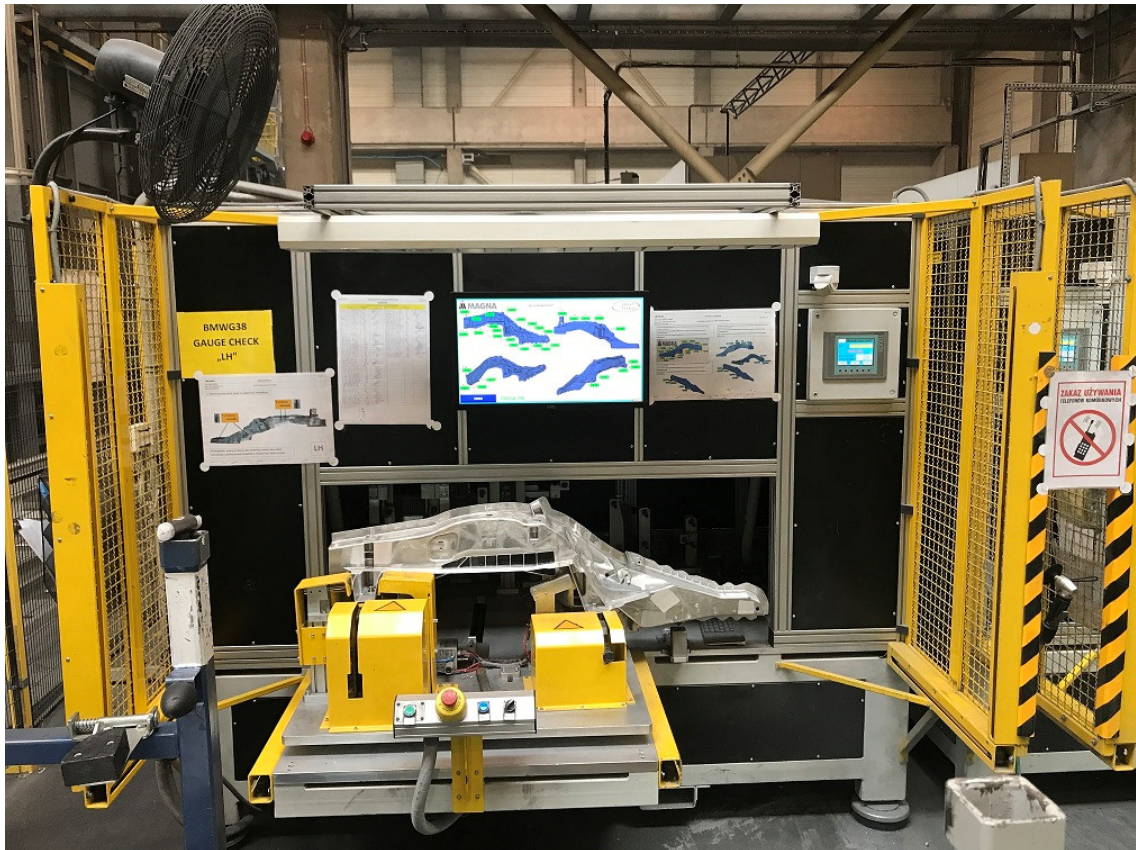
Rys.2.29. Stanowisko do pomiaru kształtu i kontroli wymiarów podłużnicy tylnej w MCP.
