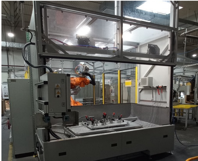
Rys.2.12. Stanowisko do wycinania próbek do badań wytrzymałościowych w spłocie MCP.
