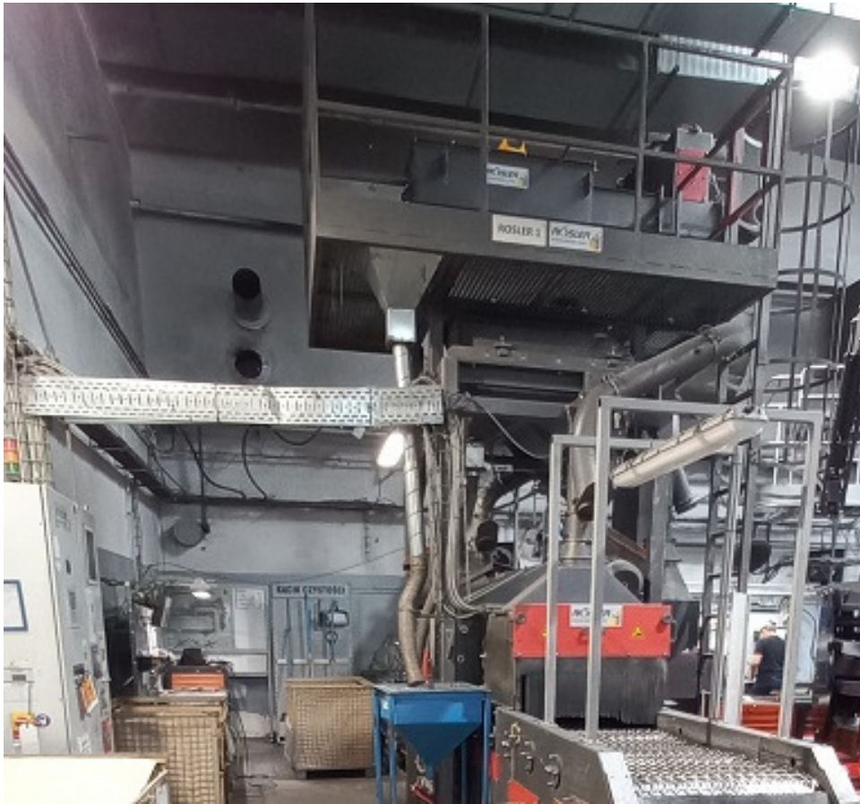
Rys.2.21. Śrutownica firmy Rossler w spółce MCP.
