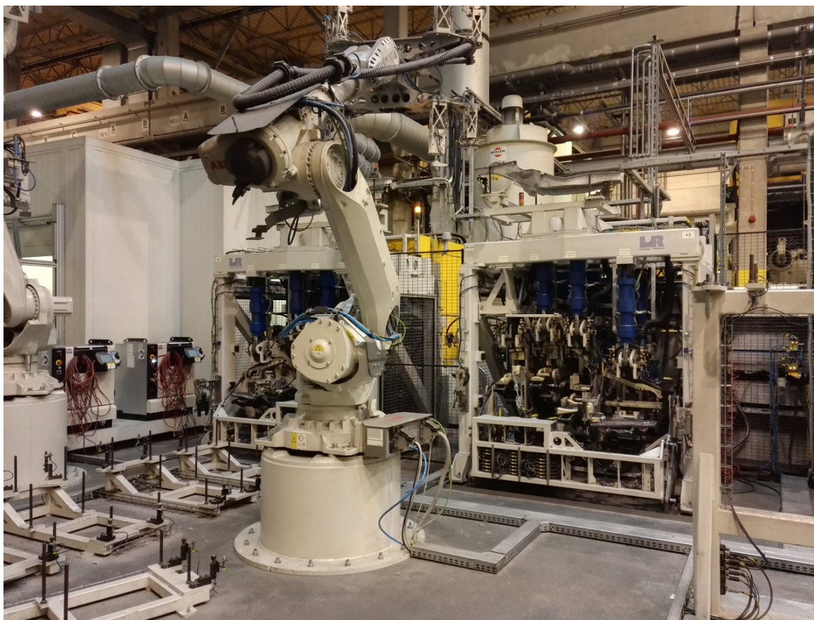
Rys.2.20. Prostownica automatyczna do odlewów strukturalnych w spółce MCP.
