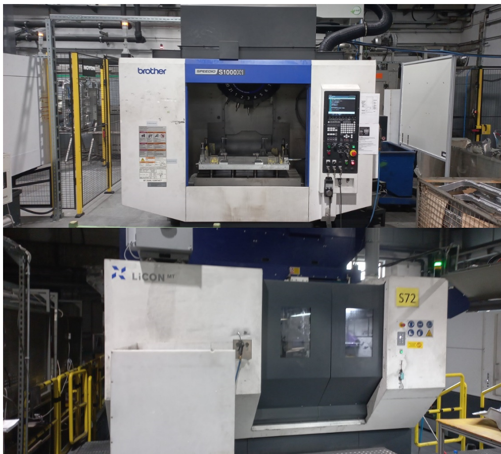
Rys.2.22. Centra obróbcze do obróbki skrawaniem detali strukturalnych w spółce MCP.
