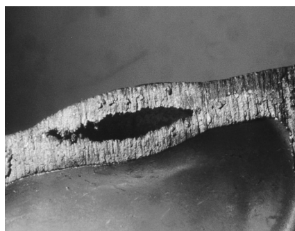
Rys.1.23. Porowatość gazowa w przekroju poprzecznym [90].
