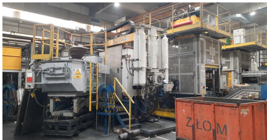
Rys. 2.5. Cella odlewnicza maszyny o sile zwarcia 1100 Mg.
