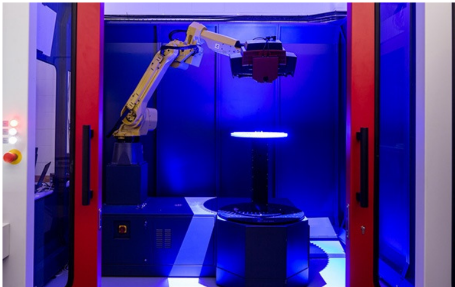
Rys.2.28. Maszyna do badań powierzchni 3D GOM w spółce MCP.
