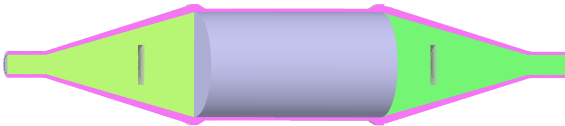
Rys. 64 Widok domeny obliczeniowej bryły strojenia oporu filtra oraz geometrii wykluczonej z obliczeń, opracowane w programie Ansys Space Claim
