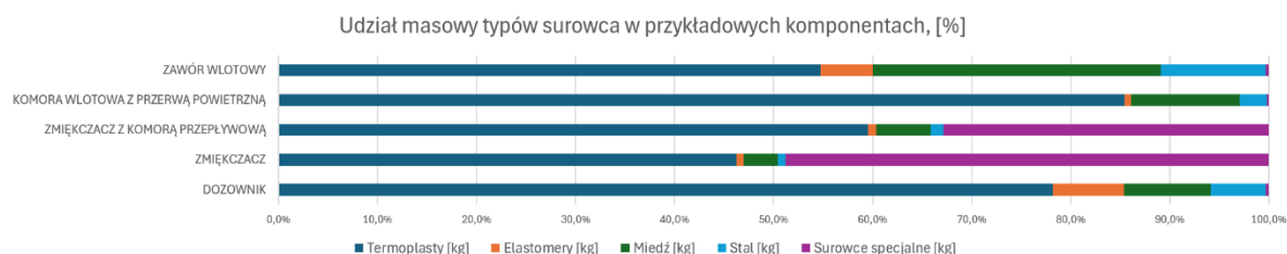
Rys. 14 Udział masowy różnych typów surowca w kompletnym wyrobie na przykładzie pięciu typów komponentów układu hydraulicznego zmywarki, opracowanie własne
