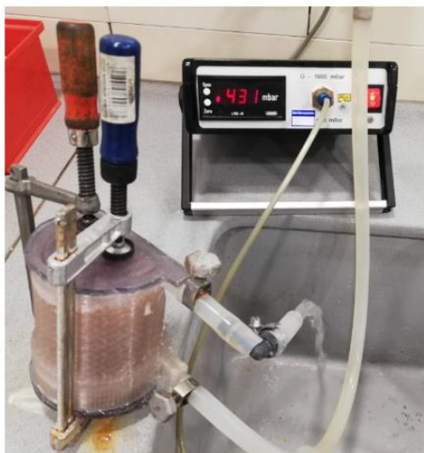
Rys. 37 Zdjęcie prototypu badawczego referencyjnego oraz wykres zmierzonego spadku ciśnienia w funkcji objętości strumienia wody
