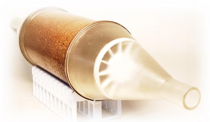
Rys. 53 Zdjęcie prototypu badawczego referencji zmierzonego spadku ciśnienia w funkcji prędkości liniowej przepływu dla kalibracji Ansys Fluent
