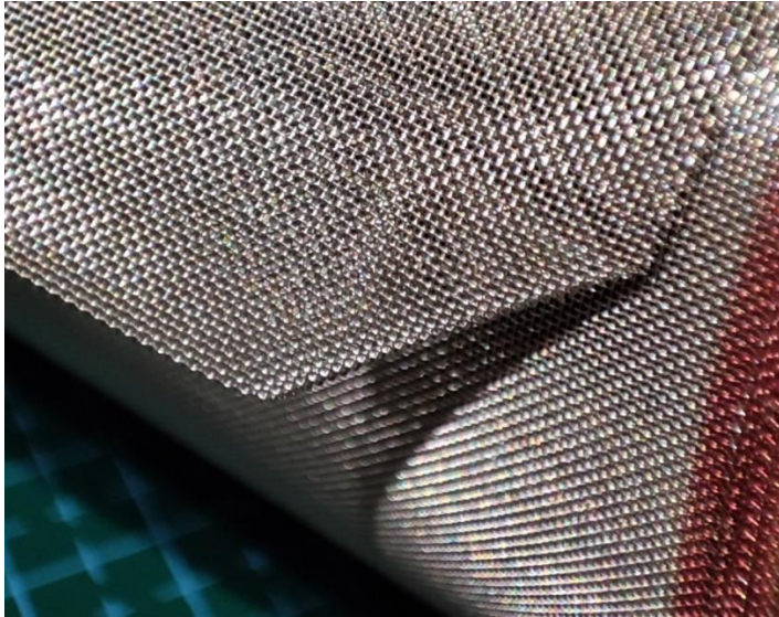
Rys. 52 Zdjęcie rolki zastosowanej siatki mesh o wymiarze oczka 0,2 m tkanej z drutu 0,15 mm
