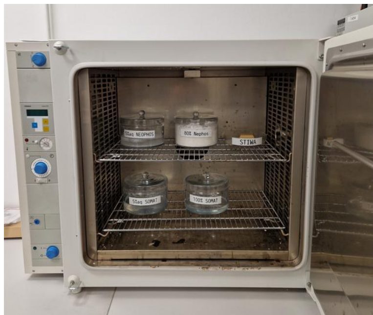
Rysunek 6. Stanowisko do badań immersyjnych próbek materiałowych w piecu.
