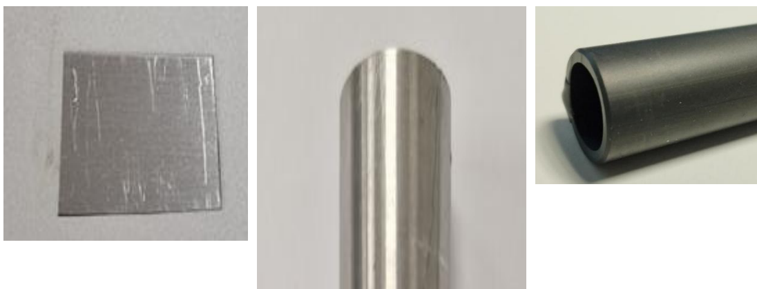
Rysunek 5. Przykładowe próbki materiałów (AL, 304ST, SSiC)
