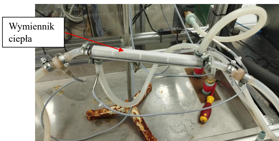
Rysunek 27. Zamontowany modułowy wymiennik ciepła w testerze badawczym.
