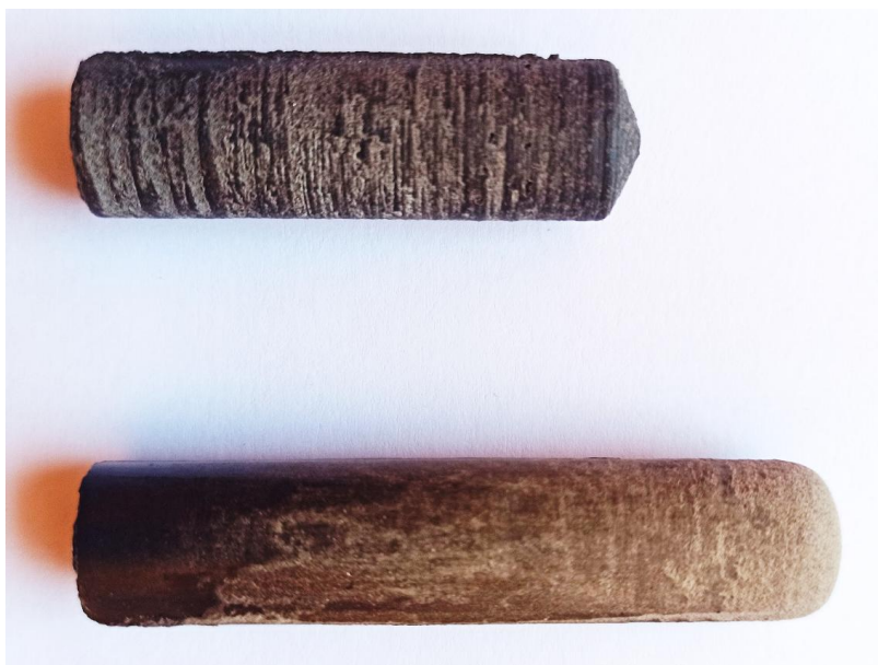
Rysunek 38. Sztyfty stosowane w technologii BFG z napełnieniem w postaci symulanta GSR
