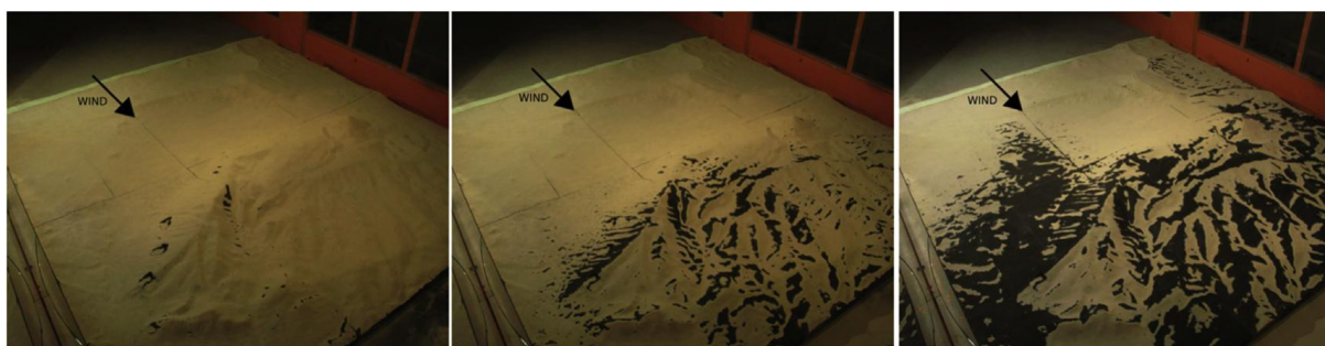
rys. 2.24 – Metoda saltacji piaskowej przedstawiona w pracy [30]. Kolejno model przed rozpoczęciem badania, po 60s nawiewu 6m/s i po 60s nawiewu 7m/s.
