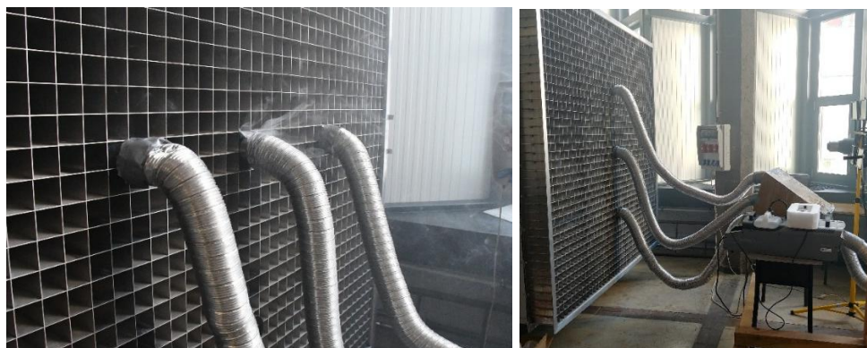
rys. 5.5 – Generator dymu w ustawieniu do zdjęć w płaszczyźnie poziomej (z lewej), i pionowej (z prawej).
