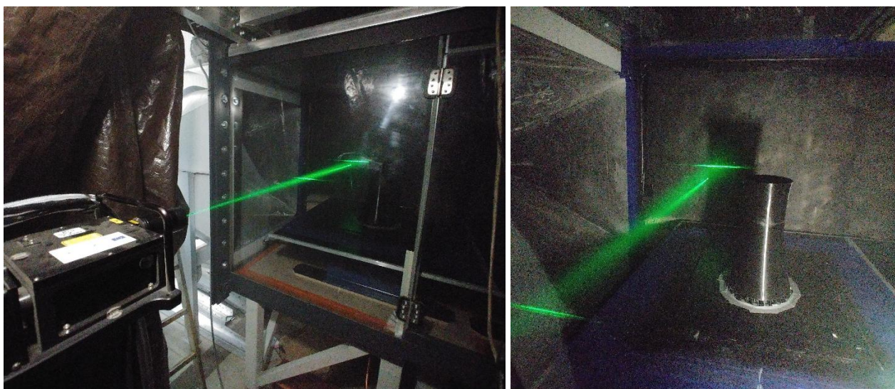
rys. 5.6 – Laser w trakcie pracy oraz model w trakcie naświetlania laserem. Otoczenie modelu pomalowane czarną farbą. Fotografie zostały wykonane przy niewielkim oświetleniu.
