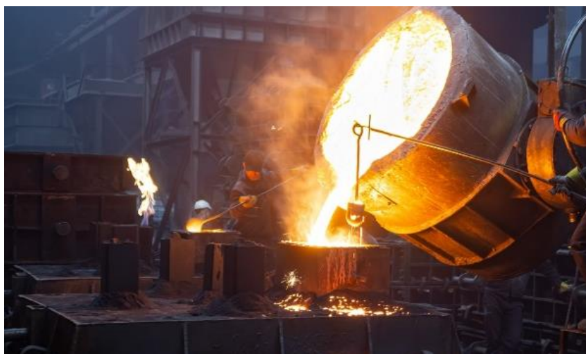
Rys. 152. Zalewanie formy odlewniczej oraz wlewka typu IV do badań własności mechanicznych i struktury
