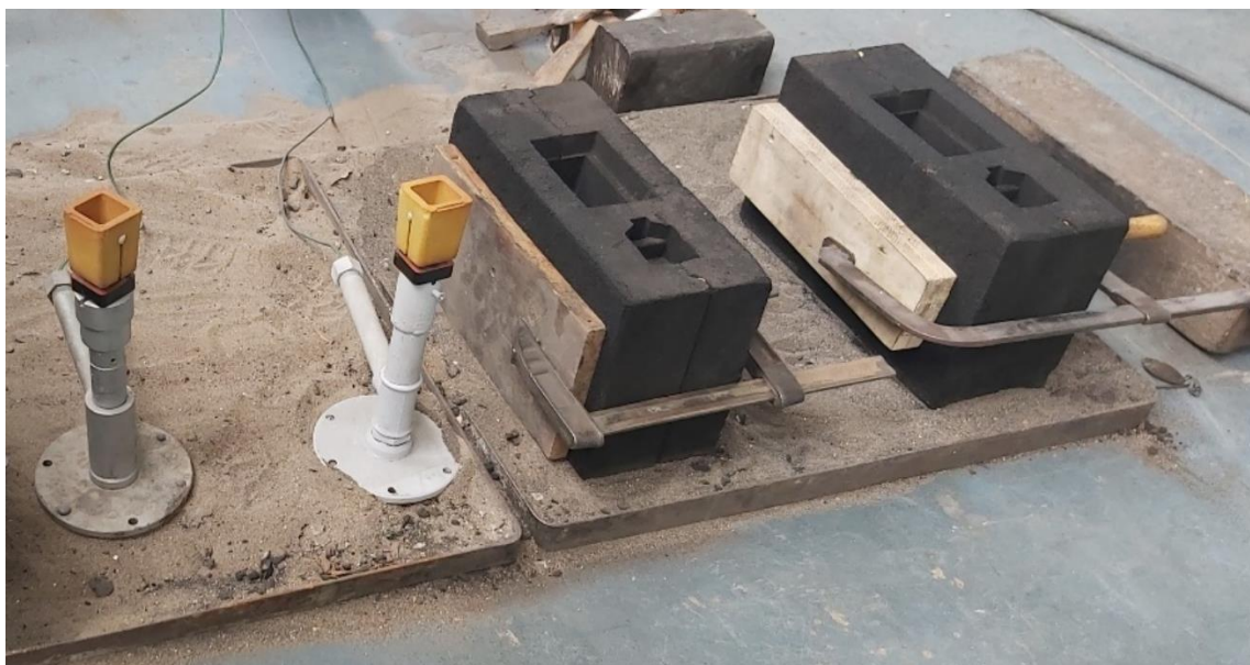
Rys. 36. Stanowisko badawcze (od lewej – 2 próbniki ATD, 2 formy prób do badań)
