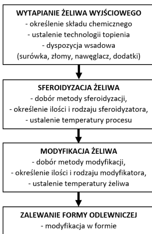
Rys. 21. Schemat procesu technologicznego wytwarzania żeliwa sferoidalnego [27]
