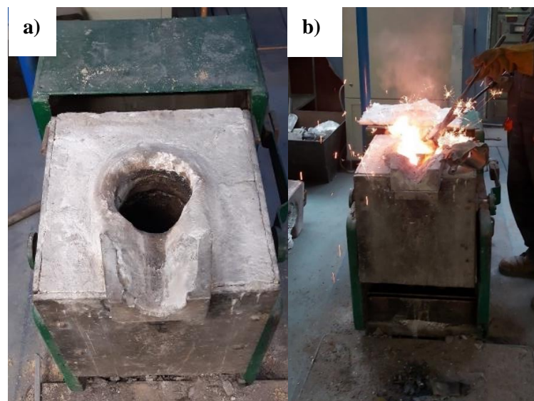
Rys. 35. Piec indukcyjny średniej częstotliwości, poj.20kg,
