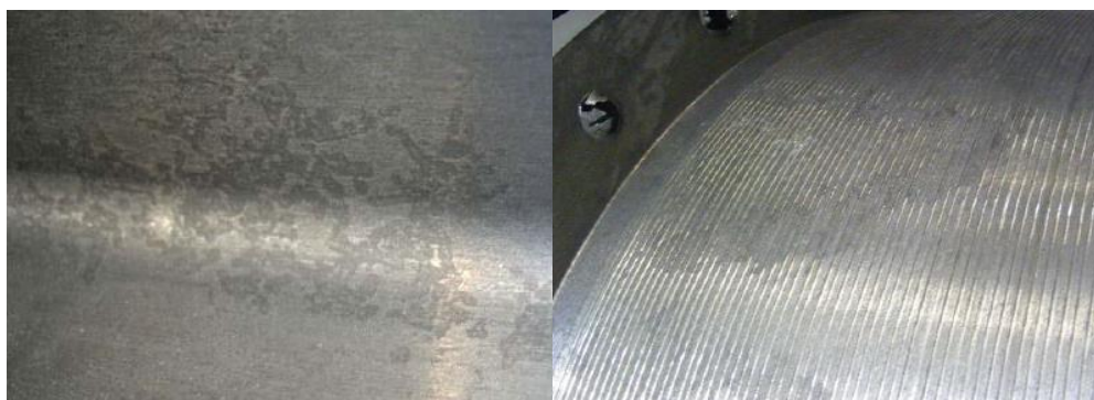
Rys. 28. Grafit chunky na powierzchni żeliwa – wady ujawnione po obróbce mechanicznej [77]
