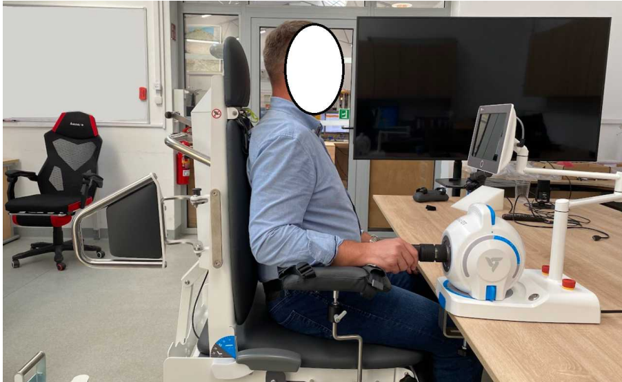
Rysunek 6.1: Użytkownik siedzący na fotelu Mezos SIT z podpartym ramieniem, trenujący na końcówce typu Pinchmeter na robocie Meissa OT
