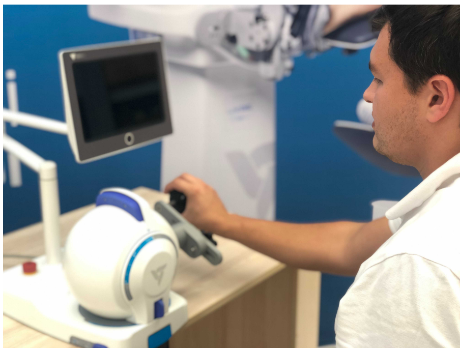
Rysunek 5.14: Meissa OT - użytkownik ustawiony frontem do stołu podczas treningu z końcówką typu kula - realizowane zgięcie / wyprost nadgarstka
