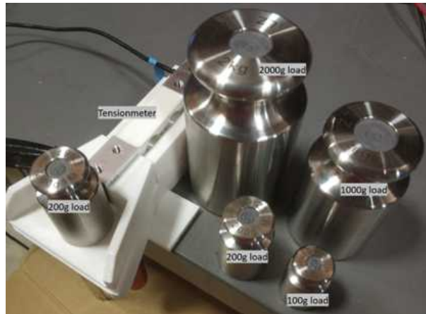
Rysunek 3.8: Układ pomiarowy oraz ciężary wzorcowane
