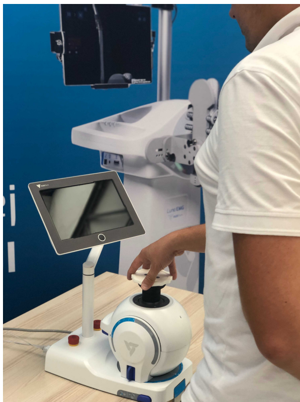
Rysunek 5.13: Meissa OT - użytkownik podczas treningu z końcówką typu dysk (rozmiar mały) w pozycji stojącej
