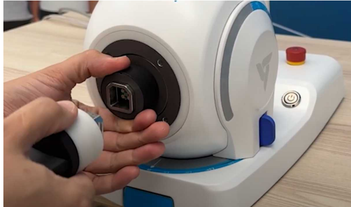
Rysunek 5.11: Meissa OT - użytkownik w trakcie demontażu końcówki z robota
