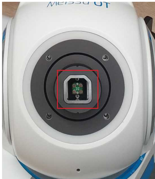
Rysunek 5.8: Meissa OT - widok na styki komunikacyjne robota (czerwone zaznaczenie)
