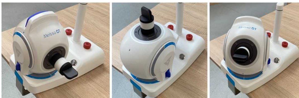
Rysunek 5.6: Meissa OT - przykładowe pozycje ustawienia głowicy robota
