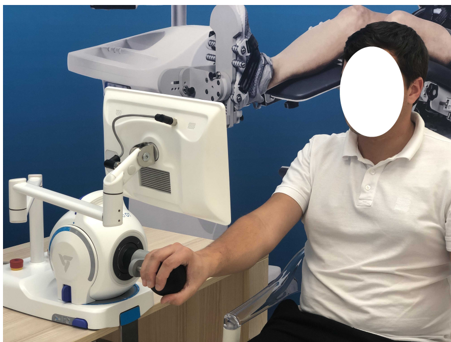
Rysunek 5.15: Meissa OT - użytkownik ustawiony bokiem do stołu podczas treningu z końcówką typu kula - realizowane zgięcie / wyprost nadgarstka
