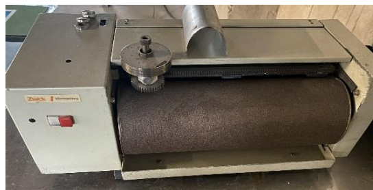
Rysunek 4.36. Aparat do badania ścieralności metodą Schoppere-Schlobacha
