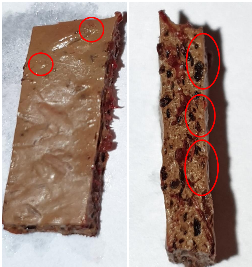
Rysunek 5.73. Biofilm wytworzony przez A. niger na powierzchni płaskiej i bocznej próbki
