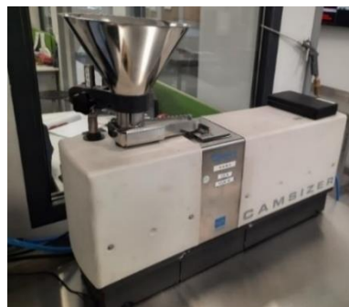
Rysunek 4.2. Przesiewacz optyczny (Camsizer)
