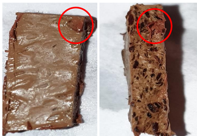
Rysunek 5.70. Biofilm wytworzony przez S. aureus na powierzchni płaskiej i bocznej próbki
