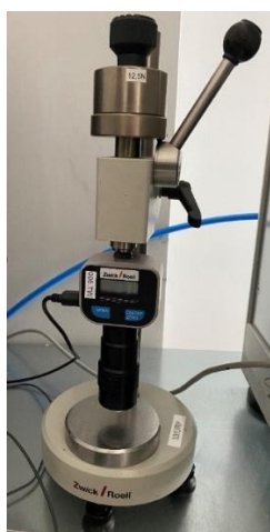
Rysunek 4.33. Twardościomierz Zwick Roell do określania twardości zwulkanizowanej mieszanki gumowej
