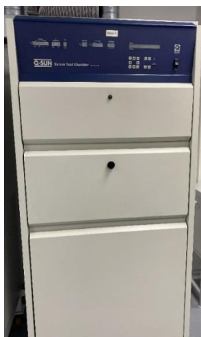
Rysunek 4.35. Ksenonowa komora do termicznych testów starzeniowych
