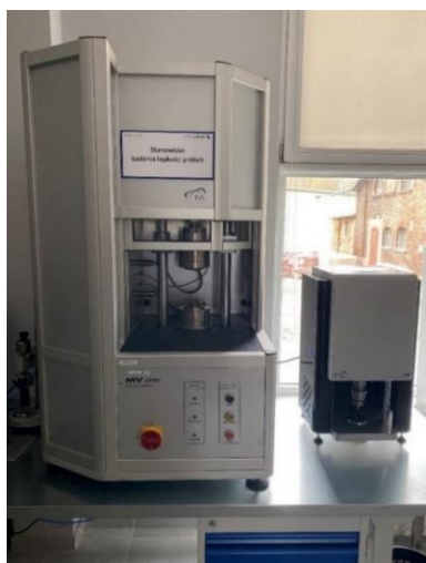
Rysunek 4.29. Lepkościomierz wraz z wykrojnikiem
