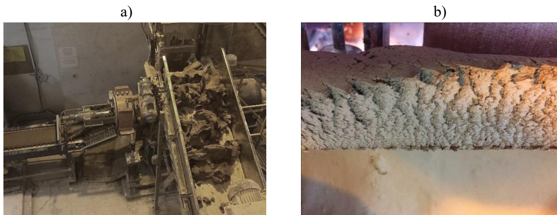
Rysunek 4.19. Wytwarzanie mieszanki gumowej z udziałem włókien z konopi indyjskich, a) na przemysłowej wylączarce jednoślindakowej, b) widok wstęgi mieszanki gumowej
