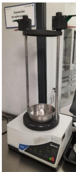
Rysunek 4.1. Wytrząsarka sitowa użyta do przesiewu surowych postaci haloizytu kalcynowanego (HK) i surowego (HS)
