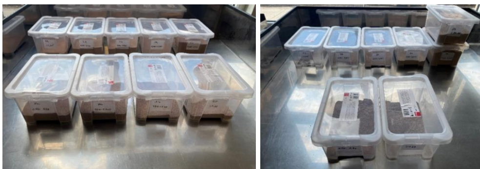
Rysunek 4.3. Frakcje haloizytu kalcynowanego (po lewej) i surowego (po prawej) po przesianiu
