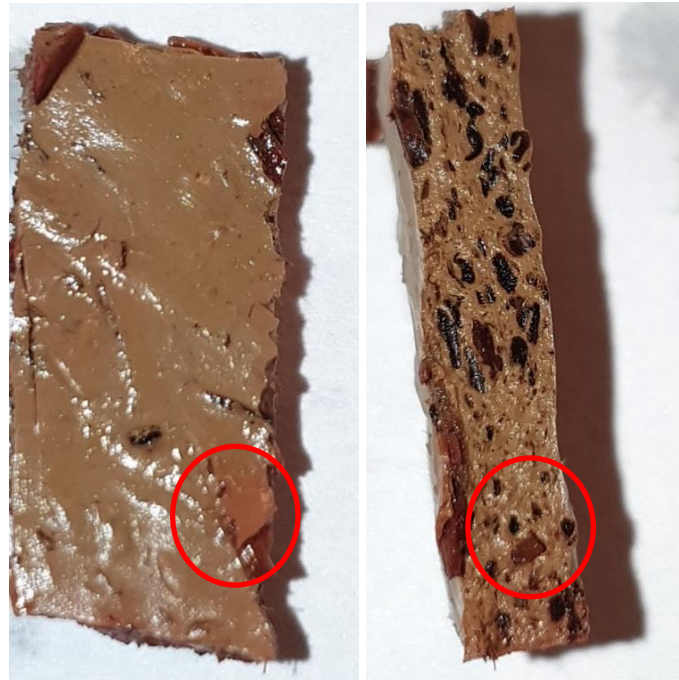
Rysunek 5.72. Biofilm wytworzony przez C. albicans na powierzchni płaskiej i bocznej próbki
