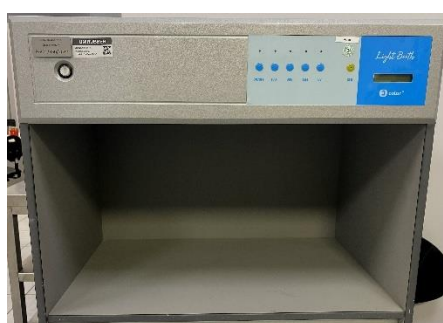
Rys. 4.31. Komora świetlna do oceny wizualnej próbek gumy
