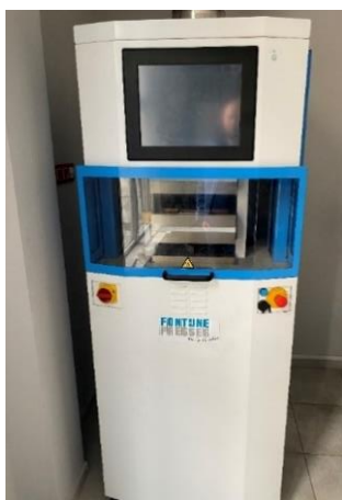
Rysunek 4.24. Prasa wulkanizacyjna laboratoryjna Fontijne
