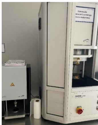
Rysunek 4.27. Wulkametr służący do określenia kinetyki wulkanizacji wraz z wykrojnikiem
