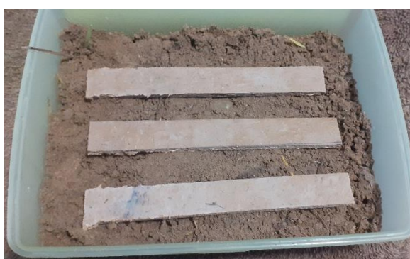
Rysunek 4.40. Widok wsadu do badań degradacji w środowisku gleby
