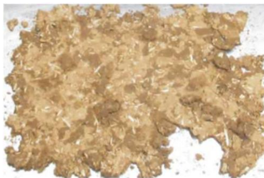
Rysunek 5.75. Widok granulatu z włóknami konopi indyjskich po testach Q-Sun
