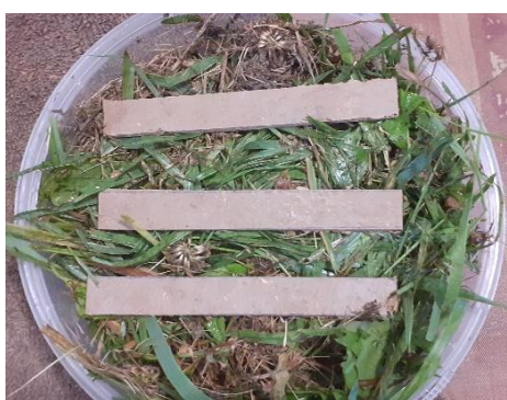
Rysunek 4.39. Widok wsadu do badań degradacji w środowisku kompostu
