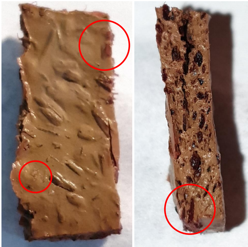
Rysunek 5.71. Biofilm wytworzony przez E. coli na powierzchni płaskiej i bocznej próbki
