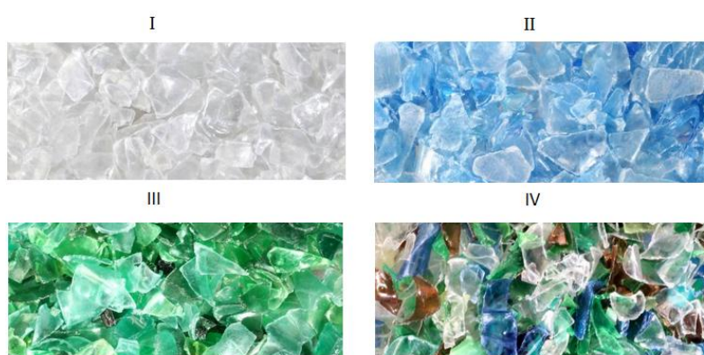
Rys 2. rPET w postaci płatków. I – bezbarwne, II – niebieskie, III – zielone, IV – MIX
