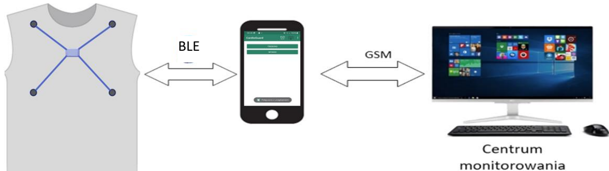
Rys.7.6 Struktura systemu względem aplikacji mobilnej
