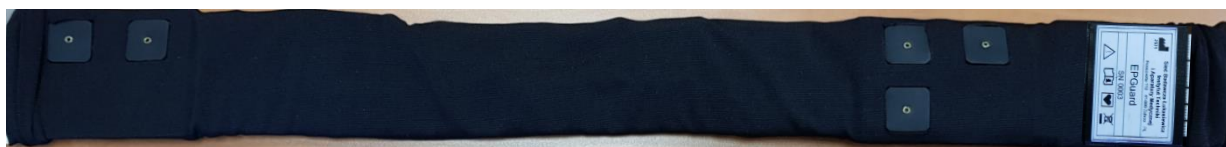
Rys.4.4.4 Prototyp elastycznego pasa diagnostycznego z usytuowaniem elektrod reograficznych
