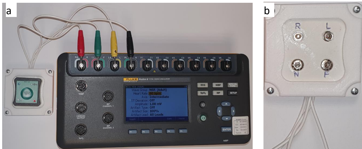
Rys. 9.1 Zadajnik sygnałów biomedycznych(a) wraz z podłączonym modulem CardioGuard, b- przyrząd zaciskowy.
