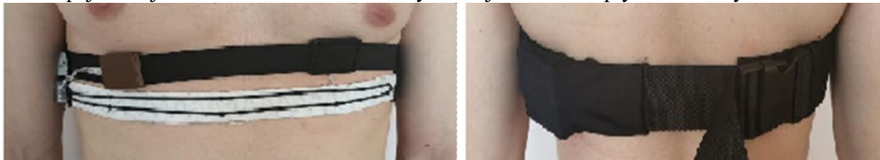
Rys.5.2.1. Praktyczna realizacja kompletnego systemu rejestracji sygnałów oddechowych z klatki piersiowej w elastycznym nośniku
