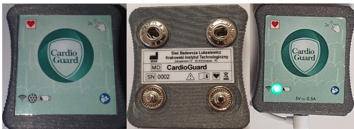
Rys.7.4.Konstrukcja mechaniczna modułu CardioGuard a) strona przednia – interfejsu użytkownika, b) strona dolna, c) wersja z ładowarką tradycyjną i złączem magnetycznym
