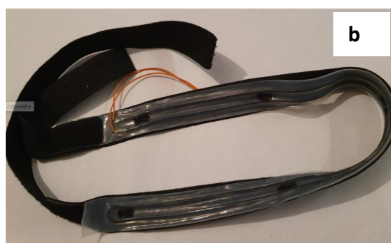
Rys.4.1.1Czujnik rezystancyjny a) elementy wykonawcze, b) doświadczalny model czujnika rezystancyjnego
