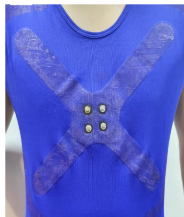
Rys. 6.15. Realizacja struktury nadruku Drugiego Prototypu koszulki tekstronicznej
