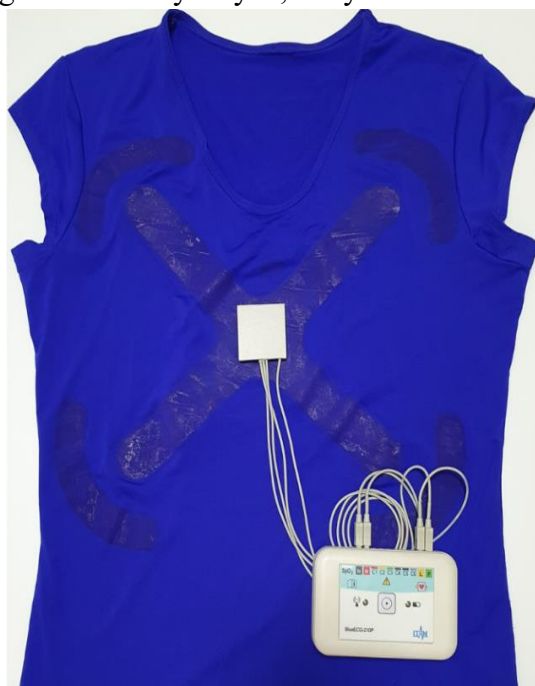
Rys. 6.16 Schemat struktury przewodzącej prototypowej koszulki tekstronicznej
