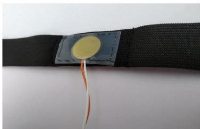
Rys.4.2.5 Aplikacja czujnika piezo w prototypowym pasie pomiarowym parametrów
