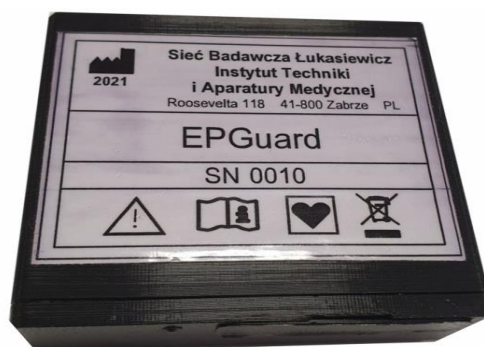
Rys.4.4.7 Kompletny moduł rejestratora fali oddechowej integrujący wszystkie czujniki
