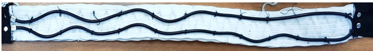
Rys.4.1.3 Zastosowanie czujnika rezystancyjnego w prototypowym uniwersalnym pasie pomiarowym
