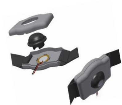
Rys.4.2.6 Model konstrukcji mechanicznej autonomicznego czujnika piezoelektrycznego
