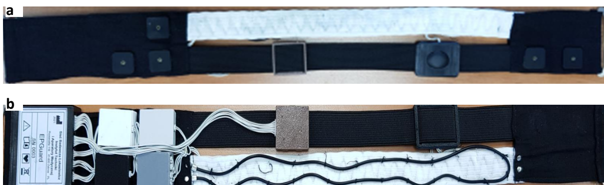
Rys.5.2.2. Praktyczna realizacja kompletnego systemu rejestracji sygnałów oddechowych z klatki piersiowej w elastycznym nośniku
