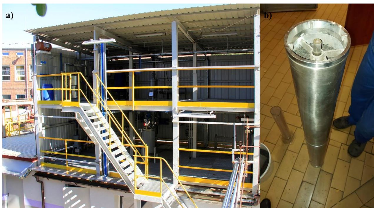
Rysunek 28 a) instalacja ćwierćtechnicznej stosowana do procesu hydrogenolizy glicerolu, b) kosz katalityczny
