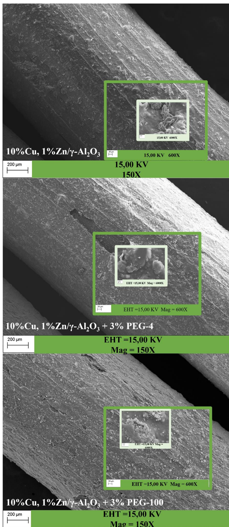
Rysunek 13 Mikrofotografie SEM dla katalizatora 10%Cu, 1%Zn/ \gamma -Al 2 O 3 : bez PEG, z PEG-4 i z PEG-100
