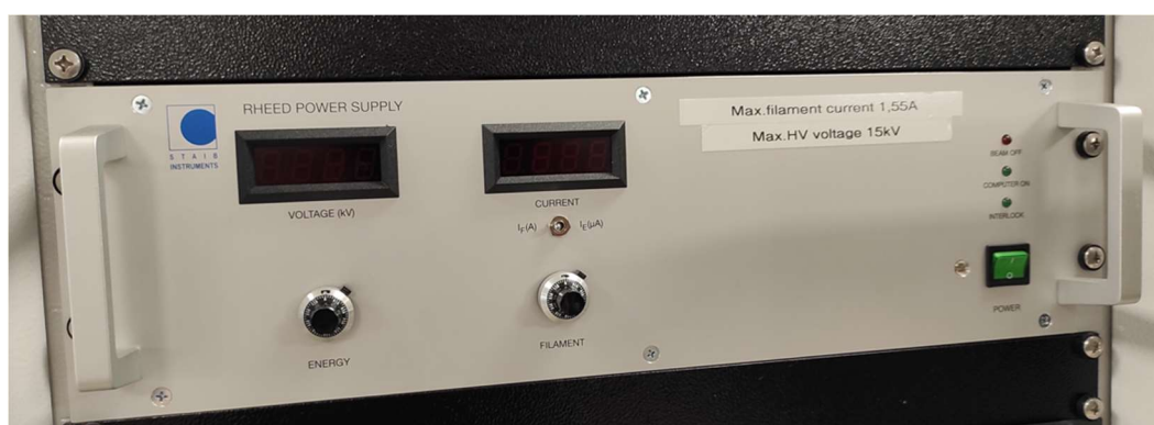
Rys. 4.35. Widok zasilacza (sterownika) dyfraktometru RHEED - model RHEED POWER SUPPLY firmy Stain Instruments (USA).
