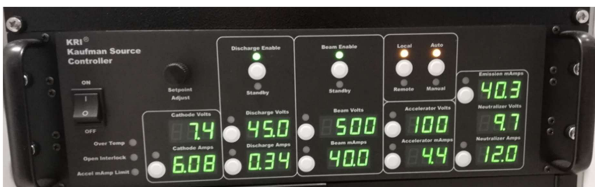
Rys. 4.11. Widok kontrolera pracy działła jonowego KDC40.
