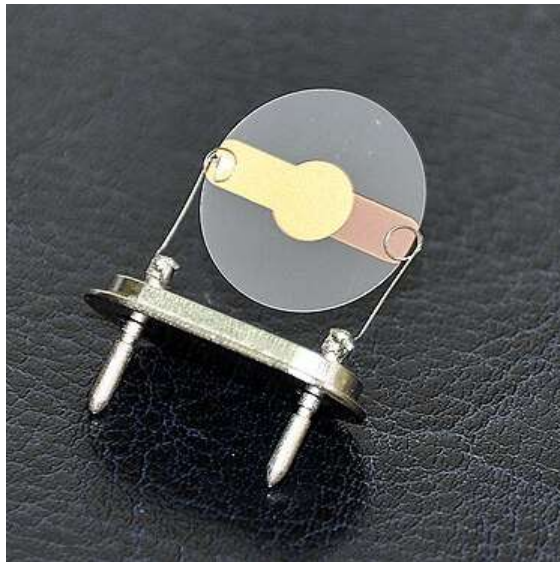
Rys. 4.29. Okrągła płytką kwarcowa z naniesionymi złotymi elektrodami.
