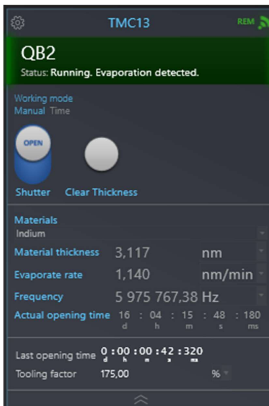
Rys.4.56. Widok panelu TMC13 sterowania pomocniczym kwarcowym miernikiem grubości (szybkości) osadzania warstw.
