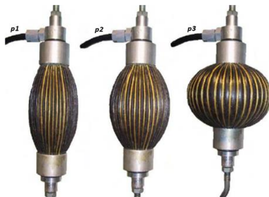
Rys. 58 Mięsień pneumatyczny i jego praca pod ciśnieniem ( p_1 < p_2 < p_3 ) [51]
