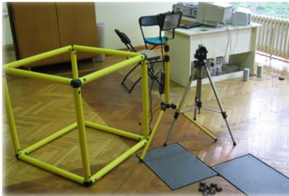
Rys. 22 Oprzyrządowanie i schemat stanowiska do badania metodą fotogrametryczną
