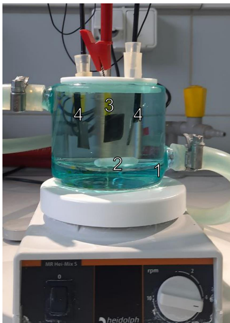
Rysunek 3. Układu wykorzystywanego w czasie elektrolizy mocznika, 1-elektrolizer z płaszczem grzewczym; 2-mieszadło magnetyczne; 3-anoda; 4-katody
