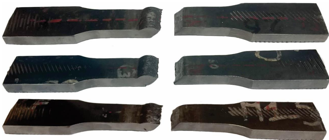
WYKRES 93: USZKODZENIE PRÓBEK 2_G3, 3_G3 I 9_M1
